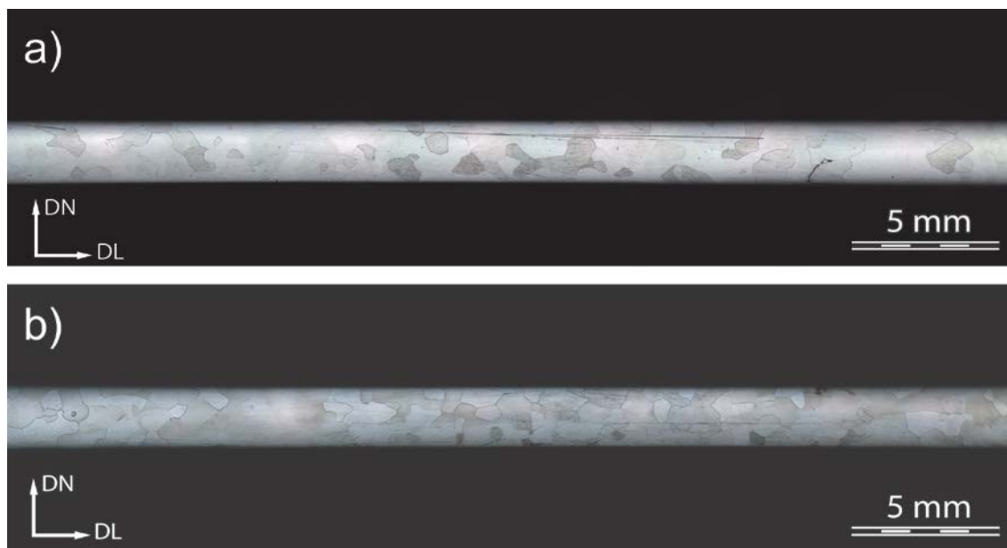
Figura 4.18 Micrografías ópticas. a) Botón laminado en caliente, b) Probeta Charpy.
