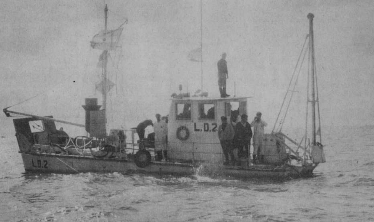
Esta embarcación está sembrando limo marcado en el Río de la Plata con el objeto de determinar los movimientos de los sedimentos depositados en el fondo, para determinar el trazado óptimo de un canal navegable.
