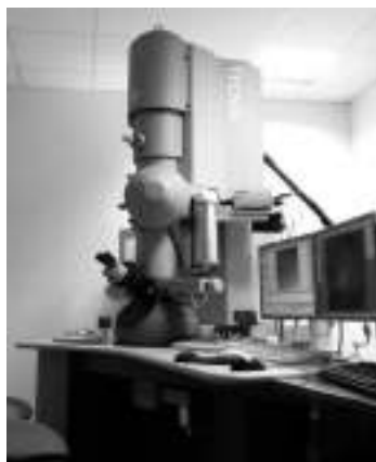
Física - Metales Microscopio electrónico de transmisión TECNAI F20 UT Centro Atómico Bariloche
