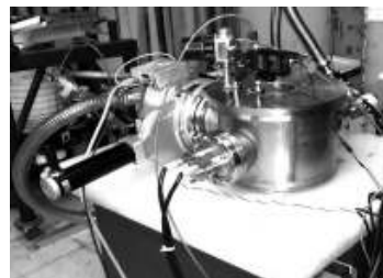
Física - Equipo para depósito de grafeno sobre cobre Centro Atómico Constituyentes
