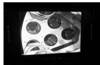
Facilidad de Almacenamiento de Combustibles de Reactores de Investigación Imagen remota de canasta de almacenamiento con combustibles almacenados
