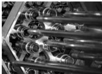
Detalle del prototipo de combustible para el reactor CAREM
