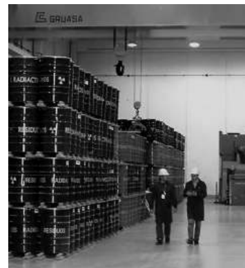
Gestión de residuos radiactivos Almacenamiento de residuos radiactivos compactados de baja actividad Área de Gestión Ezeiza
