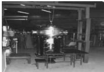
Proyecto paneles solares Cámara para emulación del ambiente espacial Centro Atómico Constituyentes
