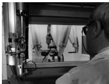
Laboratorio de Ensayos Pos Irradiación (LAPEP) Celda blindada con telemanipulador Centro Atómico Ezeiza
