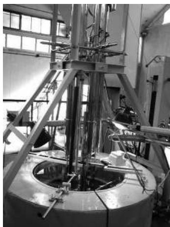
Reactor de investigación RA-1 Boca del tanque
