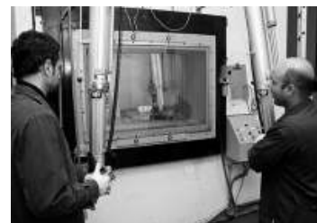
Planta de Producción de Radioisótopos Celdas blindadas con telemanipuladores Centro Atómico Ezeiza Pcia. de Buenos Aires
