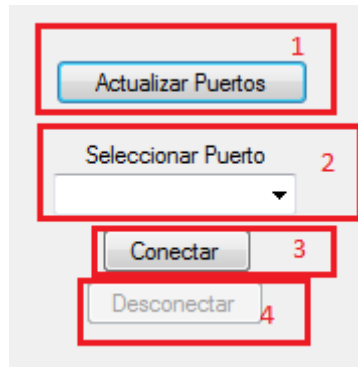
Ilustración 9 conexión a puertos
