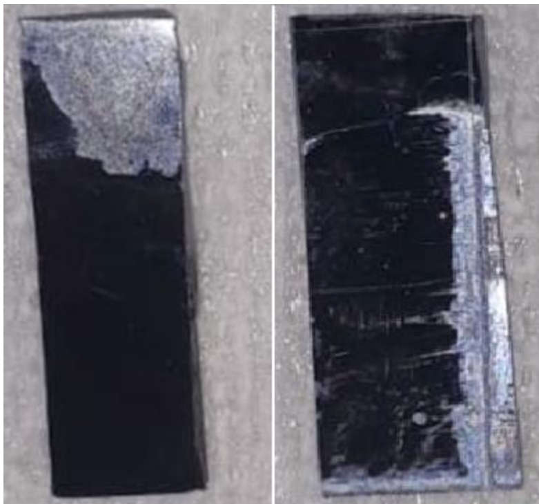
Figura 7.10: Muestras Si-G-1 (izq.) y Si-E-6 (der.) posteriores al proceso de anodizado, el cual fue creciente en potencial:
