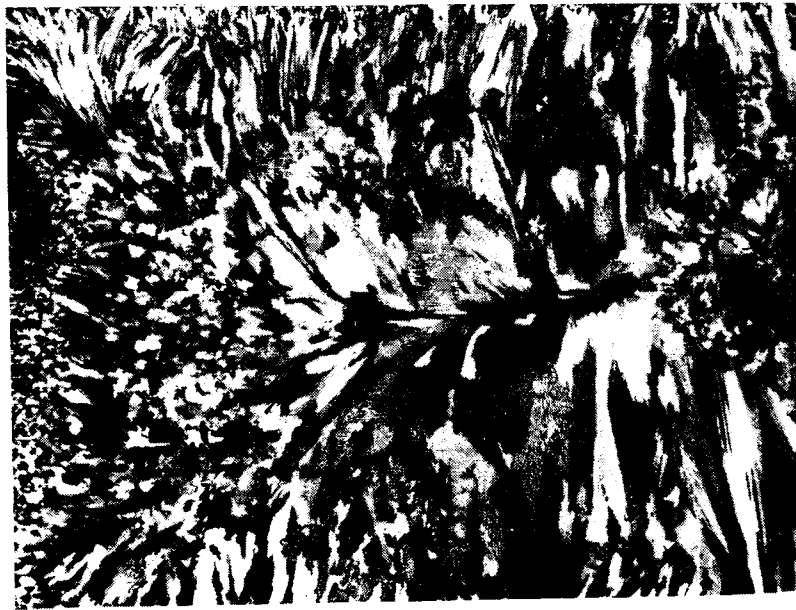
Macrografía de un lingote de cobre de 99.99% de pureza obtenida en el laboratorio de metalografía óptica,
