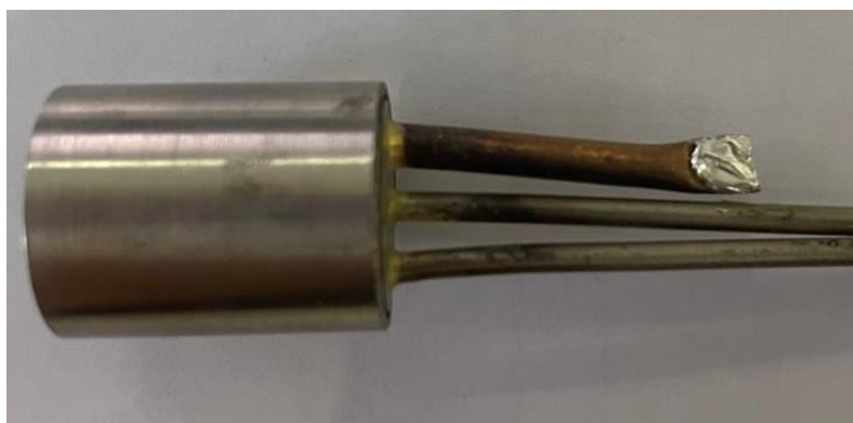
Figura 23 Tubo de cobre prensado y estañado.
