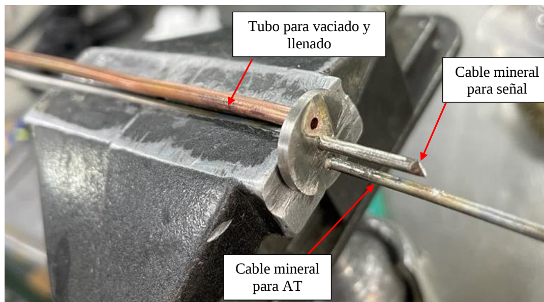
Figura 3 Tapa soldada con cables minerales y tubo de cobre.
