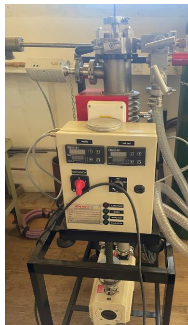
Figura 21 Sistema de vaciado y llenado.
