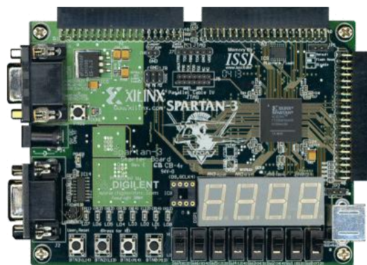
Figura 2.4. Kit de desarrollo de la empresa Digilent para diseños digitales. La placa cuenta con una FPGA Xilinx Spartan-3.
