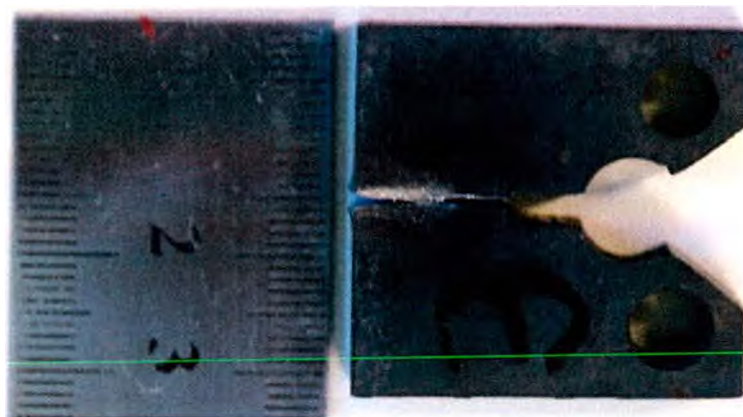
Figura 51: Fotografía de probeta C(T) acero B
