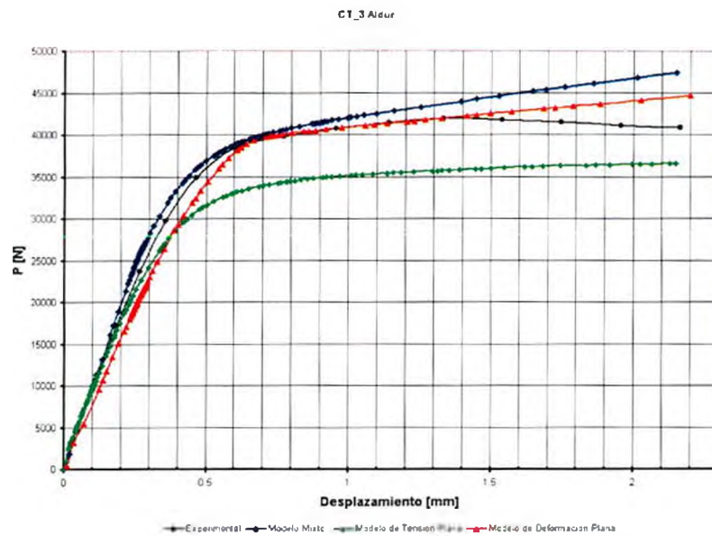
Figura 4 : Comparación de resultados en tensión plana y deformación plana.
