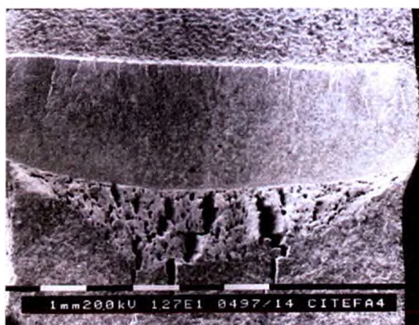
Figura 35: Vista de delaminación en probetas fractomecánicas acero B
