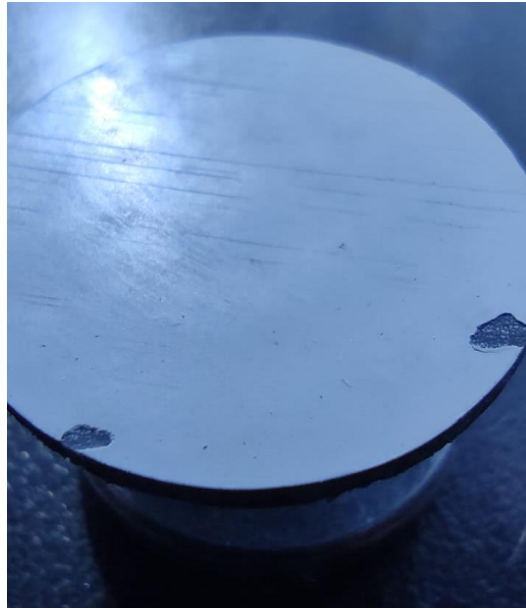
Figura 70: Detalle del modo de falla (falla de cohesión entre capas de pintura) del recubrimiento A.
