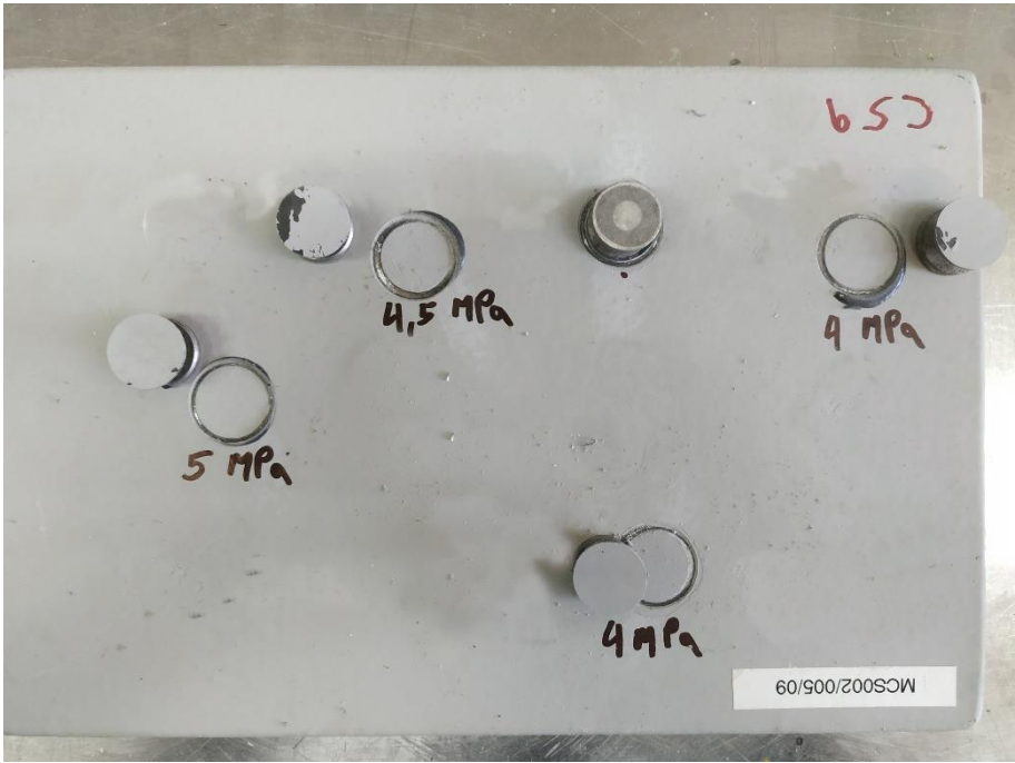
Figura 69: Mediciones realizadas en la placa de referencia del recubrimiento A, donde pueden verse los modos de falla.
