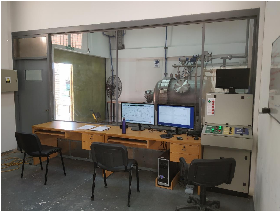
Figura 40: Vista general del laboratorio, donde pueden observarse la cámara de ensayos y el pupitre de mando.
