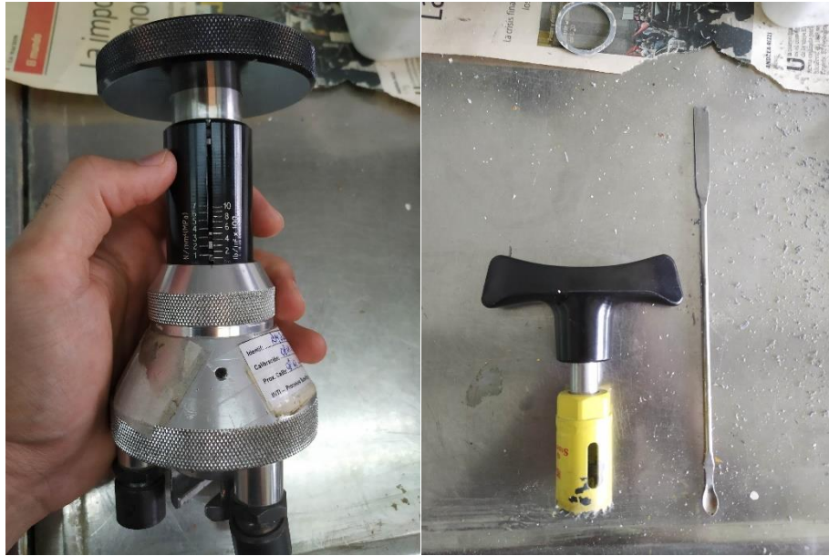
Figura 38: De izquierda a derecha se presenta el dispositivo para realizar el ensayo y la mecha de copa para generar la hendidura alrededor del doli.
