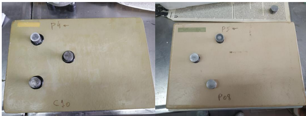
Figura 52: A la izquierda se observa el cambio de coloración del recubrimiento A y a la derecha el correspondiente al recubrimiento B.
