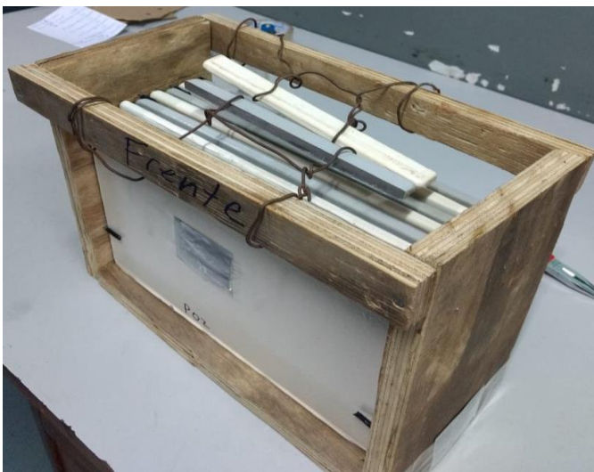
Figura 36: dosímetro frontal y disposición de un set de muestras compuesto por 8 placas.
