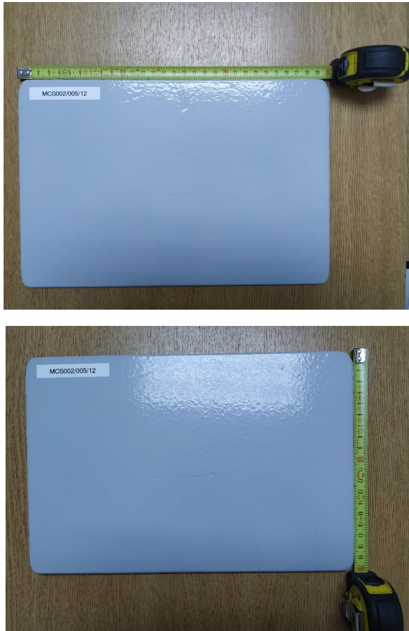
Figura 29: placa de 300mm x 200mm x 8 mm con el recubrimiento A (color gris).
