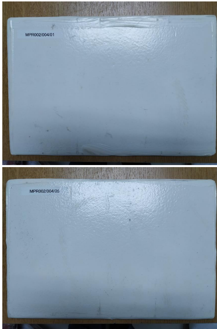
Figura 30: Placa de 300mm x 200mm x 8 mm con el recubrimiento B (color beige).
