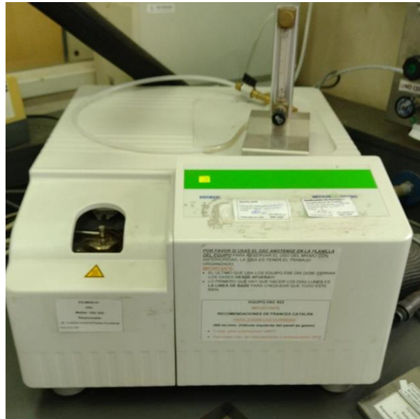
Figura 33: Calorímetro diferencial de barrido, modelo DSC822e, marca Mettler Toledo.
