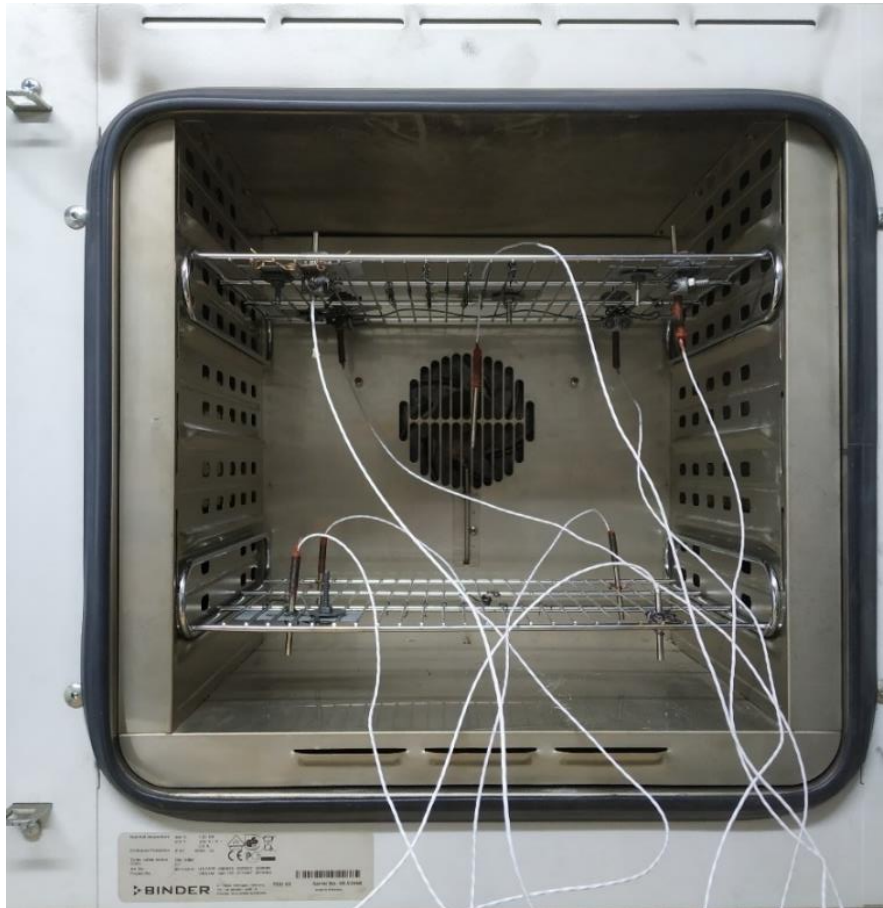
Figura 79: Disposición espacial de las 9 termo resistencias.
