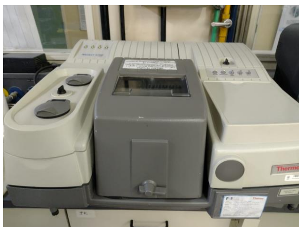
Figura 32: Espectrómetro infrarrojo por transformada de Fourier, modelo Nicolet 5700, marca Thermo Electron Corporation.
