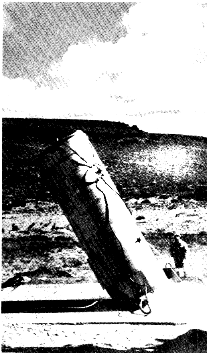
Ensayo de caída libre desde 9 metros de un contenedor para transporte de elementos combustibles tipo MTR
