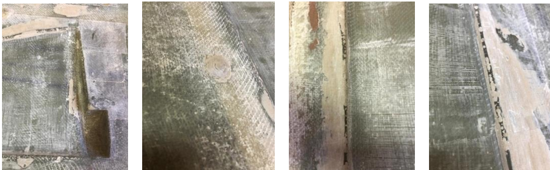
Figura 4.8- Pulido y enmasillado de imperfecciones molde.
