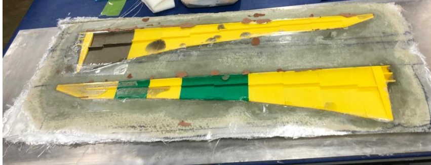
Figura 4.6- Inconvenientes desmolde molde
