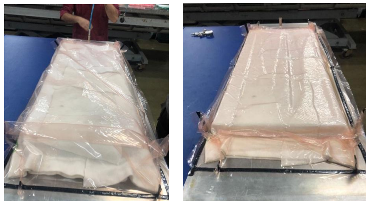
Figura 3.14 – Laminado del álabe conectado al vacío (izquierda), desconectado al vacío luego de 30 min (derecho).
