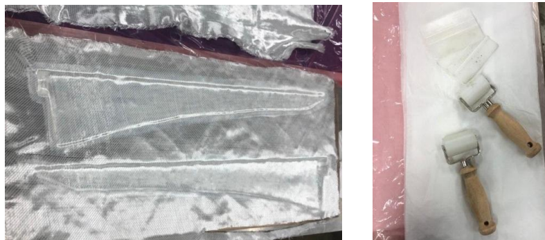
Figura 3.13– Proceso laminado álabe
