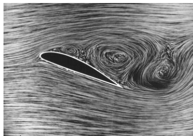
Figura 2.2 - Entrada en pérdida de un perfil aerodinámico.
