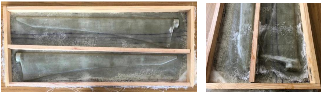
Figura 4.7- Parte posterior molde con soporte (imagen izquierda), refuerzos aplicados (imagen derecha).
