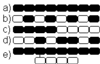
Figura 1: a) Homopolímero; b) Copolímero alternante; c) Copolímero en bloque; d) Copolímero aleatorio; e) Copolímero de injerto.
