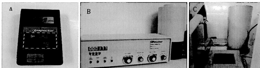
Figura 10. Instrumentos de medición de la radiactividad. A) monitor portátil GeigerMuller; B) contador de centelleo sólido (CCS) y C) activímetro con pantalla para selección de nucleidos.
