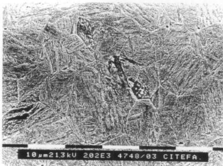
Figura 4.3a: Acero A02 enfriado con V_{enf} de 10 °C/s, autorrevenido (2000X).
