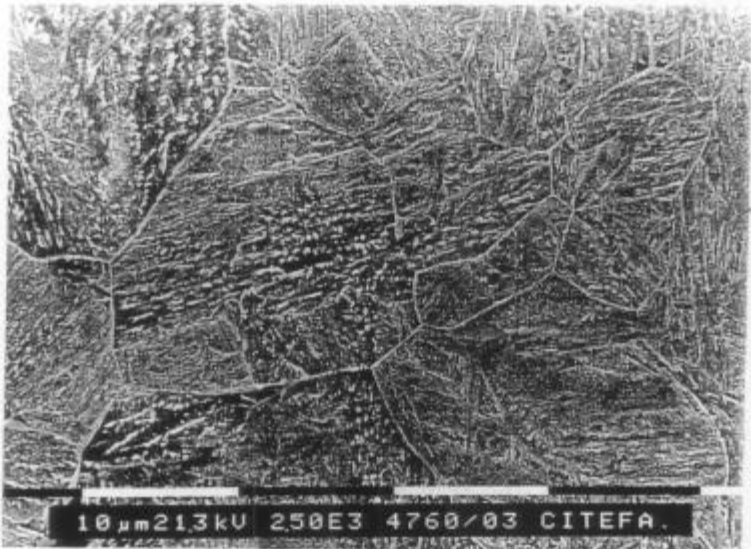
Figura 4.4: Acero A02 enfriado con V_{enf} de 5 °C/s, autorrevenido (2000X).
