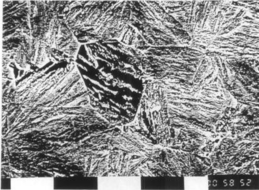
Figura 3.13a: Acero A01, Venf. = 27 °C/s. (2000X).
