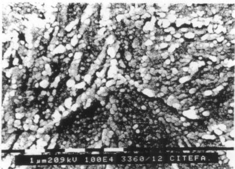
Figura 4.7: Acero A11 templado y revenido a 600 °C - 15 min (10000X).
