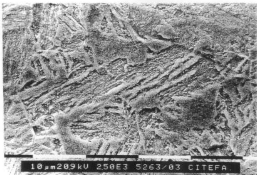
Figura 3.16a: Acero A11, Venf. = 5 °C/s. (2500X).
