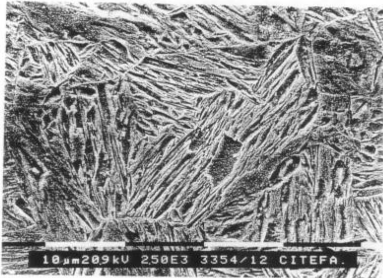
Figura 4.5a: Acero A11 templado y autorrevenido a plena escala en planta (2500X).
