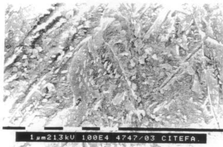
Figura 4.3b: Acero A02 enfriado con V_{enf} de 10 °C/s, autorrevenido (10000X).
