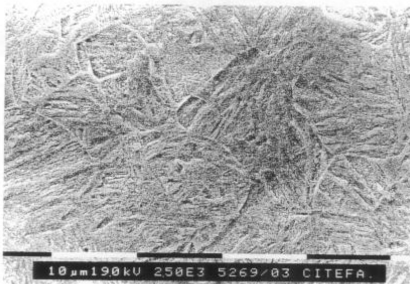
Figura 3.17a: Acero A24, Venf. = 2.5 °C/s. (2500X).
