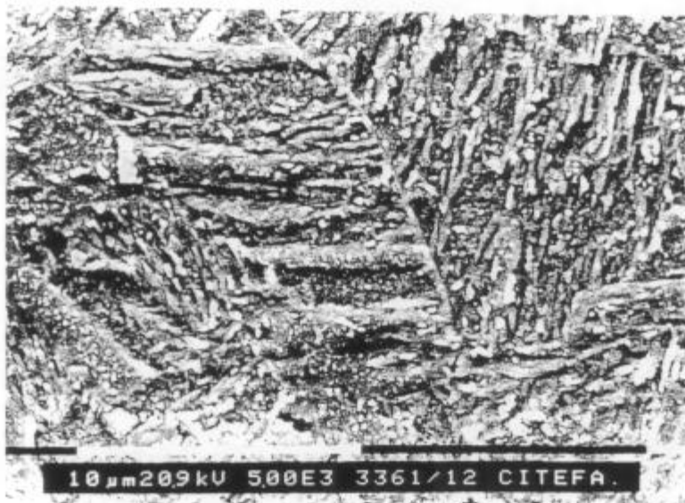
Figura 4.6a: Acero A11 templado y revenido a 450 °C - 15 min (5000X).
