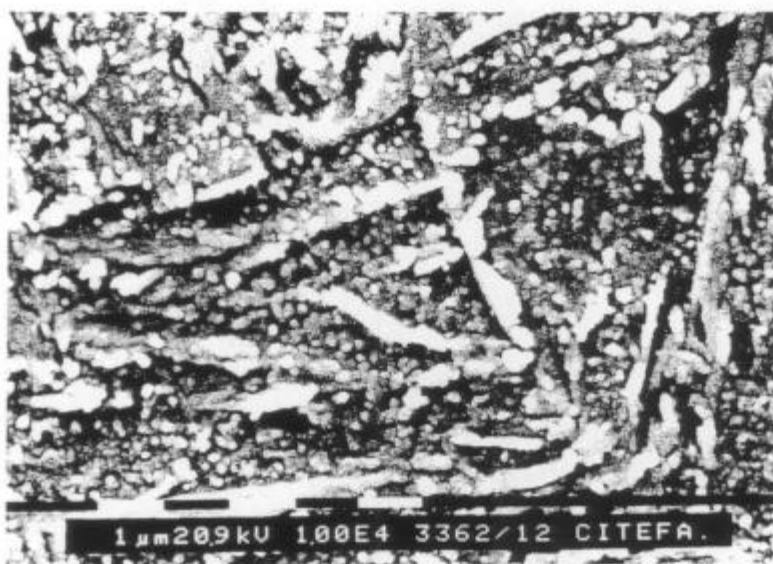
Figura 4.6b: Acero A11 templado y revenido a 450 °C - 15 min (10000X).
