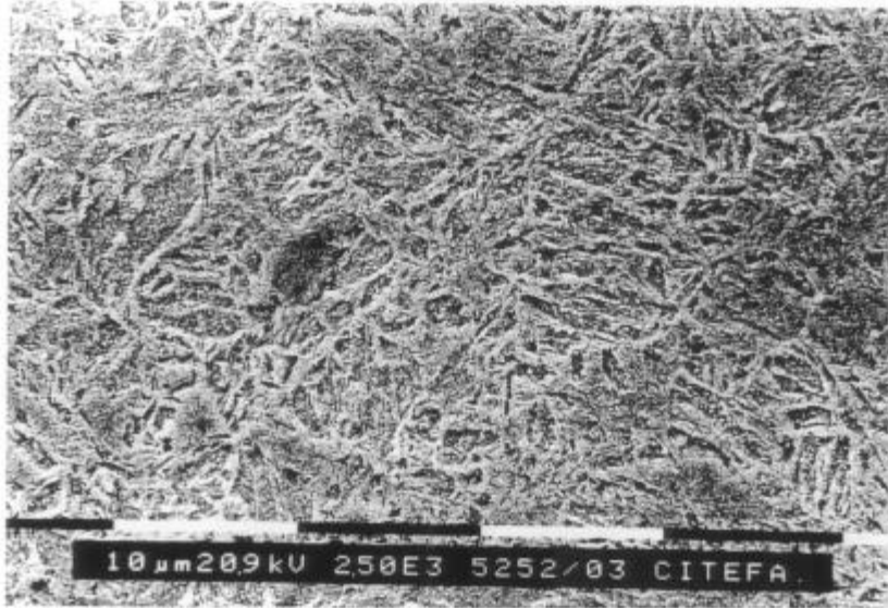
Figura 4.14: Acero A24 templado y revenido a 450 °C - 15 min (2500X).
