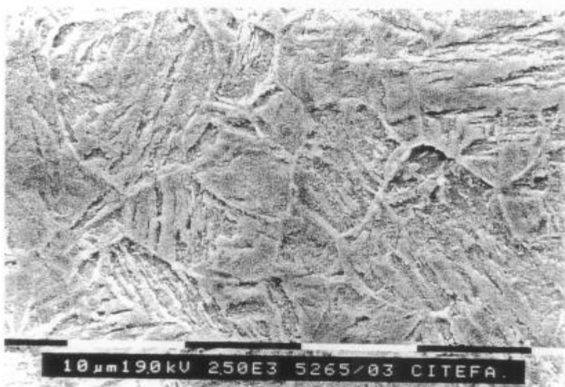
Figura 3.16b: Acero A11, Venf. = 5 °C/s. (2500X).
