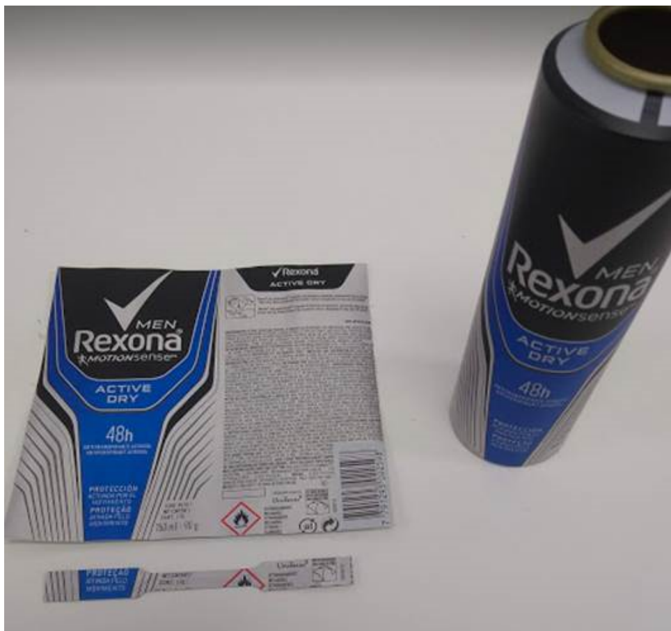
Figura 3.14. Probeta de tracción extraída a partir de un envase final extruido. Puede verse la dirección de extracción de la probeta.
