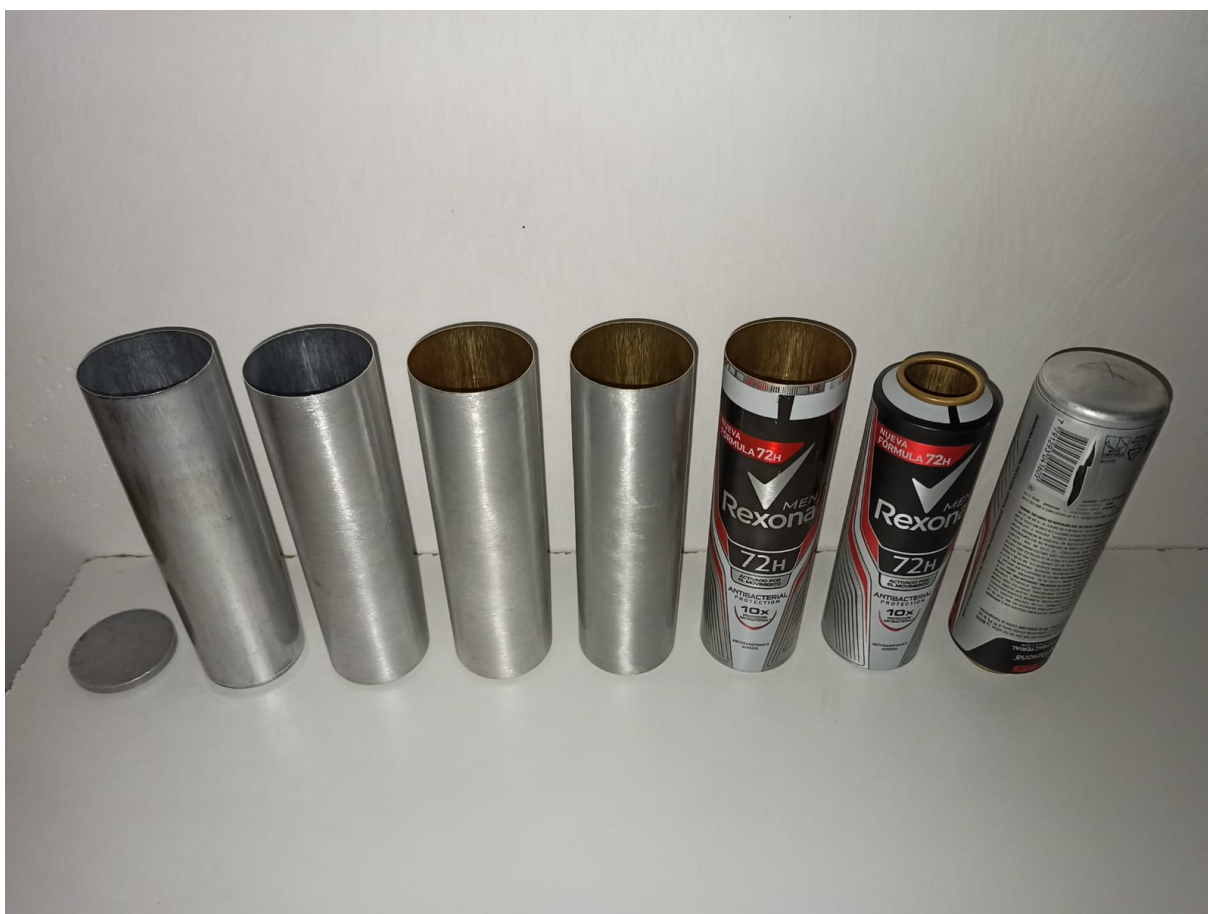
Figura 3.1. Etapas de producción de un envase fabricado por Trivium Packaging. Desde el tejo (izquierda), pasando por las etapas intermedias de extrusión, cepillado, esmaltado, impresión y formado final, Finalmente hay un envase ensayado a explosión (derecha).
