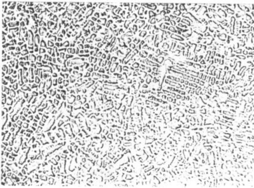
Figura 18. Microestructura de la aleación cobalto-cromo (300x).
