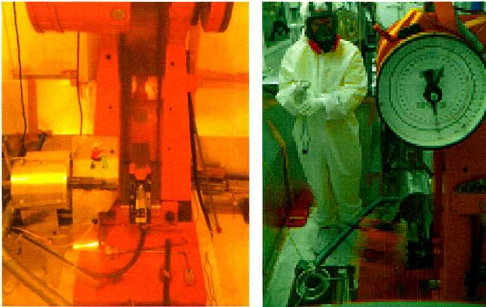
Figura III.13: Máquina Charpy instrumentada instalada en el CELCA- LAPEP y el autor de esta tesis realizando un ensayo.
