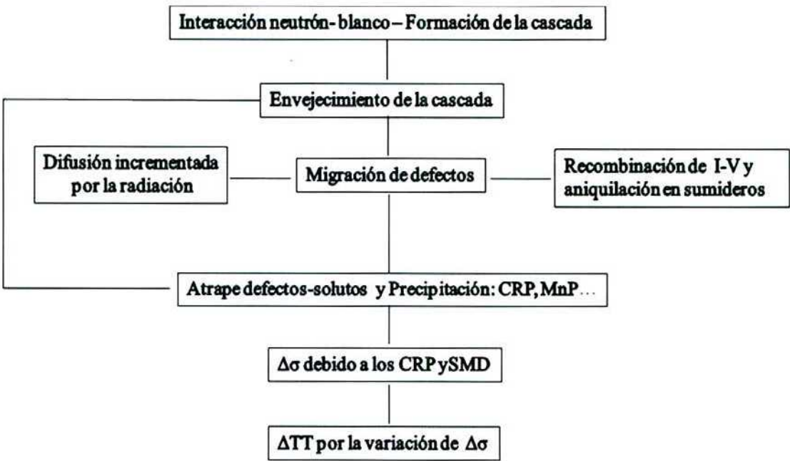
Figura VI.1: Esquema simplificado de la secuencia de eventos que llevan al corrimiento de la DBTT por acción de la radiación.
