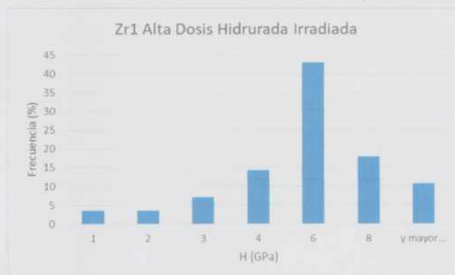
Figura 59: Comparación histogramas de dureza con y sin irradiación en Zr 1%p Nb hidrurado.
