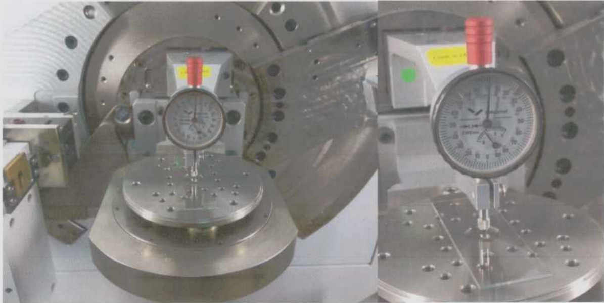
Figura 48: Muestra montada en el difractómetro sobre un vidrio portaobjeto, junto con el reloj comparador utilizado para la alineación de la altura.
