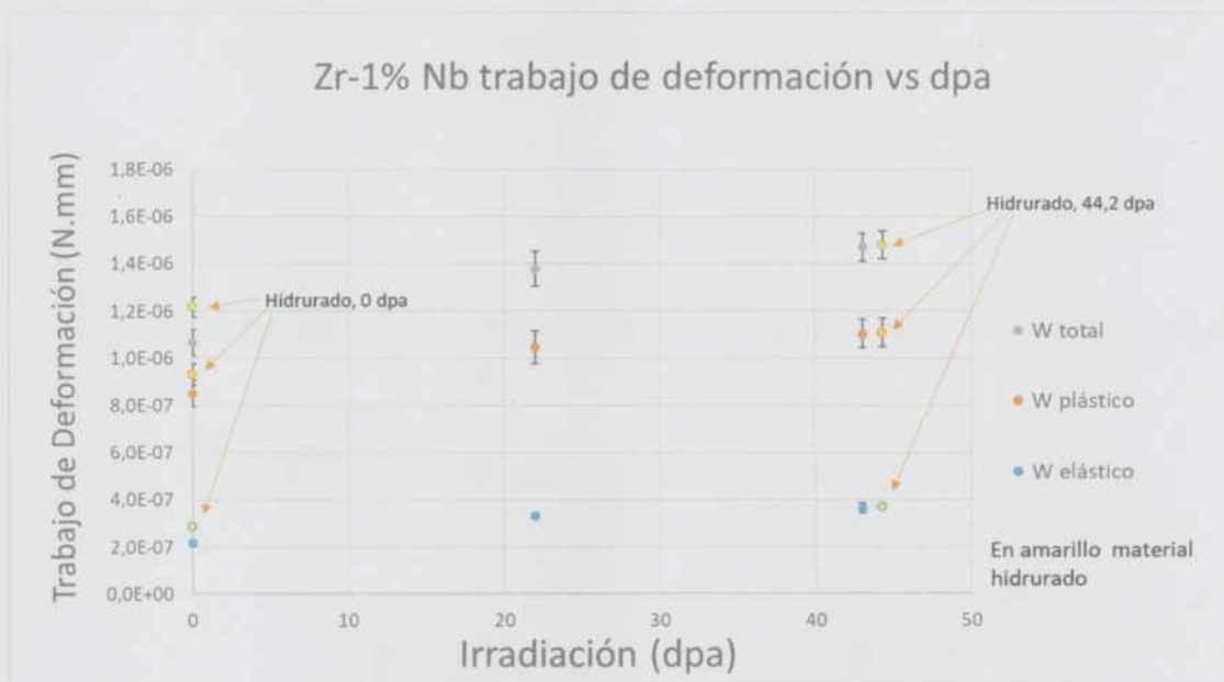
Figura 74: Trabajo de deformación para Zr 1%p Nb.
