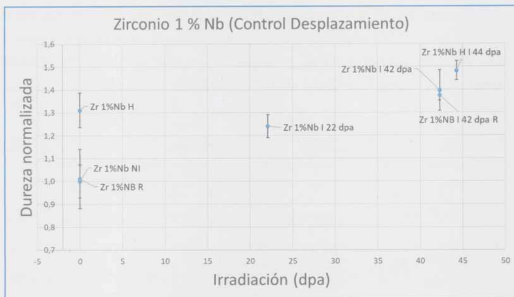
Figura 71: Dureza normalizada para Zr 1%p Nb.
