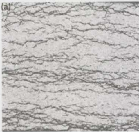
Figura 8: Hidruros en Zry, (a) sin tensiones y (b) con tensiones aplicadas [25]
