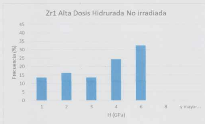
Figura 58: Comparación histogramas de dureza con y sin irradiación en Zr 2.5%p Nb.
