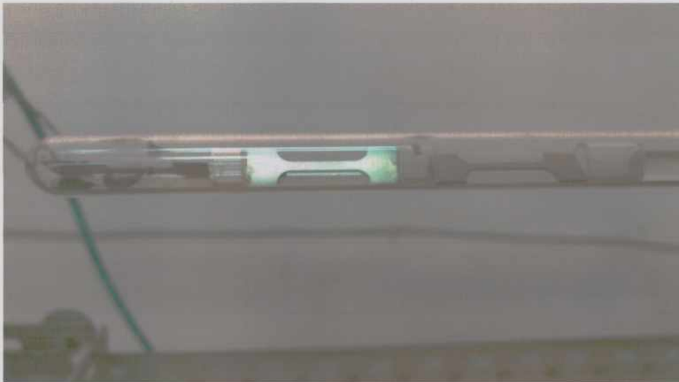
Figura 37: Detalle de las probetas en el dispositivo de hidruración por carga gaseosa
