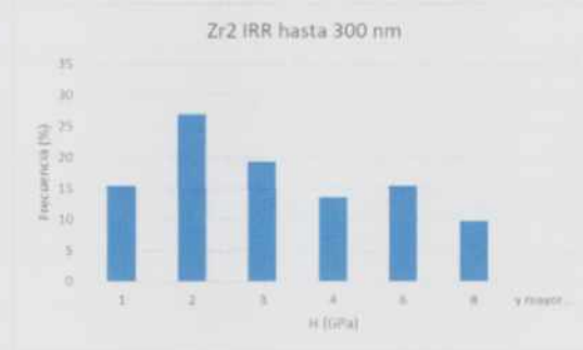
Figura 58: Comparación histogramas de dureza con y sin irradiación en Zr 2.5%p Nb.
