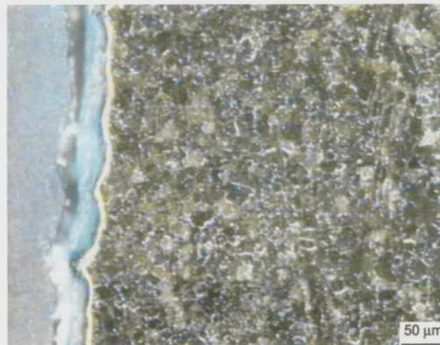
Figura 3: Zircaloy expuesto a altas temperaturas; se observa la capa de zirconia [19].
