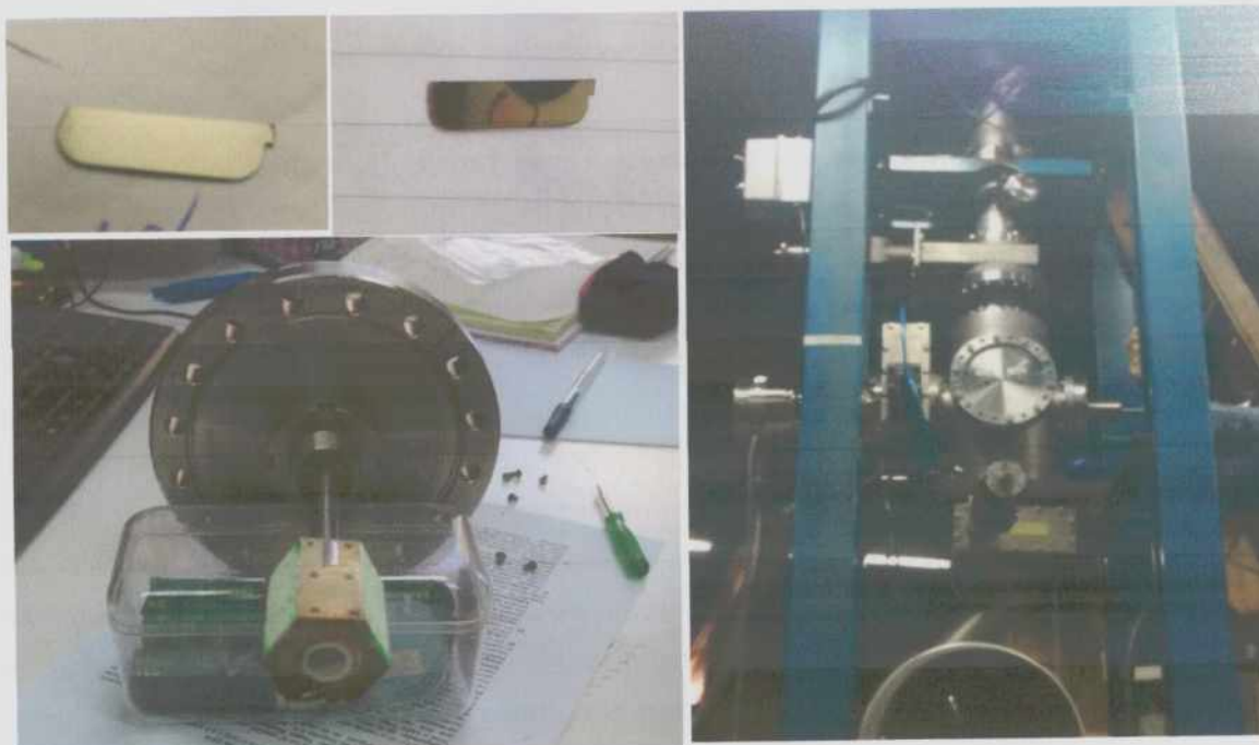
Figura 40: Detalle de las probetas utilizadas para irradiación, porta muestras y vista general del implantador de iones de acelerador TANDAR.
