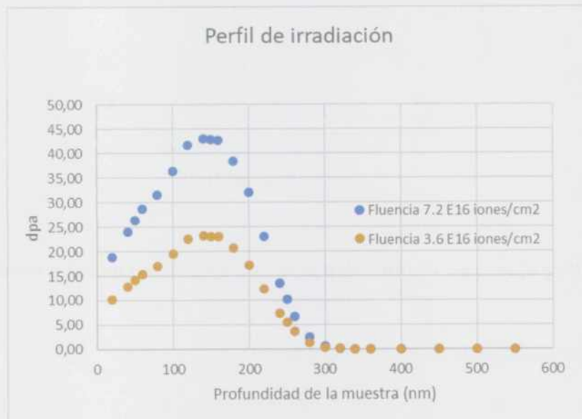
Figura 65: Curva de penetración de iones carbono. Valores de dpa en función de distancia a la superficie. Los valores máximos se alcanzan a 170 nm de la superficie.
