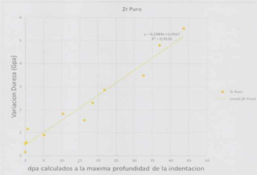
Figura 68: Correlación entre incremento de dureza y dpa a la máxima profundidad del indentador. Se muestra el ejemplo del Zr puro.
