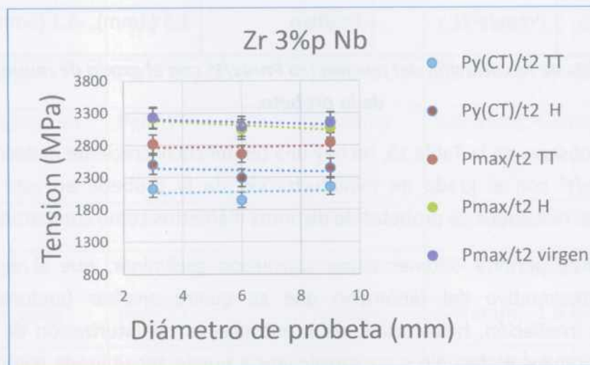
Figura 53: Variación de parámetros mecánicos obtenidos por ensayo SPT con la reducción de diámetro de la probeta.
