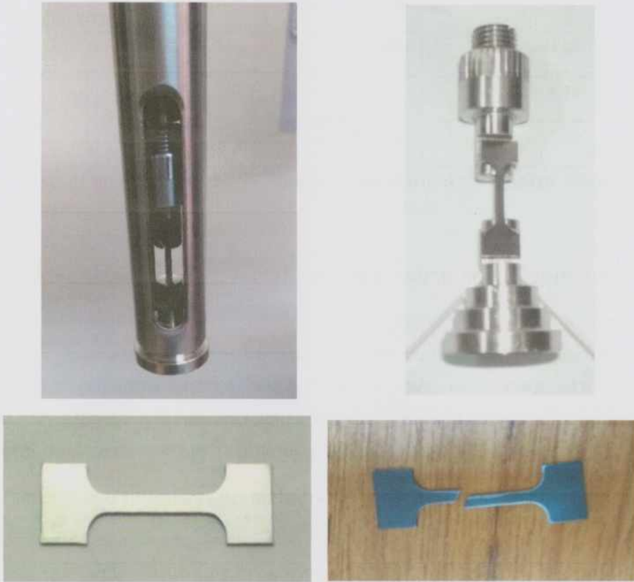
Figura 38 : Probeta miniatura y sistema de tracción diseñado para minimizar la dosis
