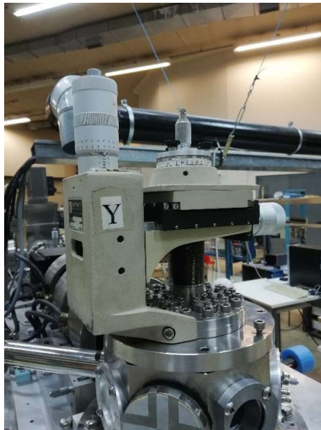
Figura 22 Microposicionador montado sobre la cámara de irradiación.
