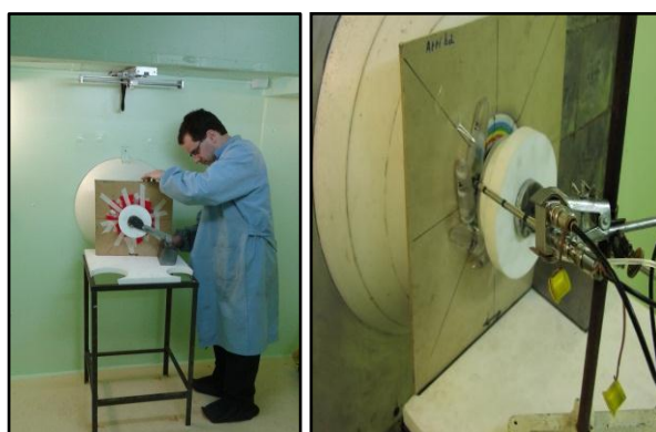
Figura 17. Dispositivo de irradiación y reflector-dispersor de neutrones.
