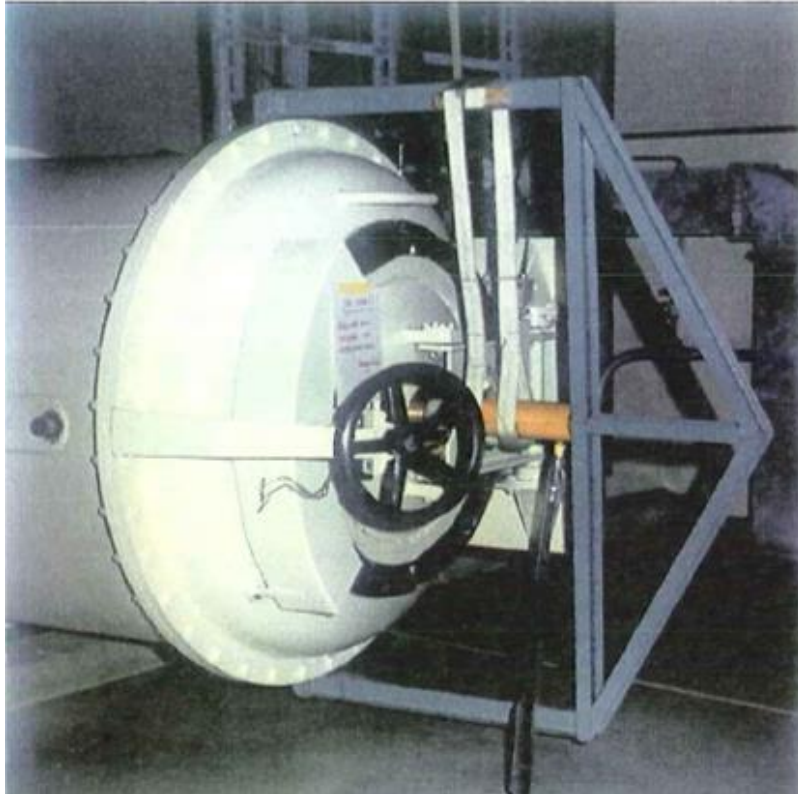
Figuras N° 17 – Esclusa de Emergencia – Puerta Exterior (edificio anular) con mecanismo de bloqueo para prueba repetitiva
