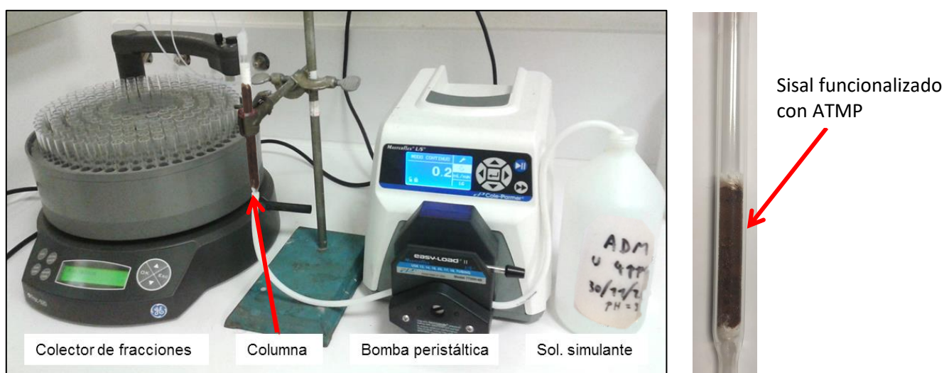
Figura 3.5: Armado del sistema de adsorción de uranio de ADM mediante columna.
