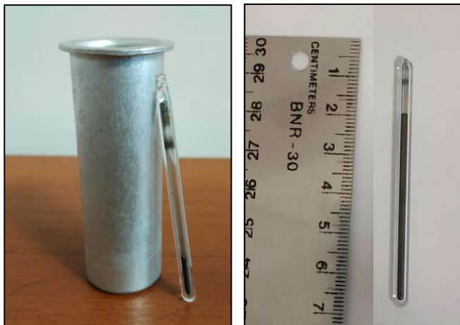
Figura 3.26: Ampolla de cuarzo con muestra junto al envase de aluminio utilizado para la irradiación en el RA-3.
