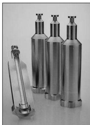
Figura 1.6: Blancos utilizados en ANSTO hasta 2006. Comprenden envases de aluminio cargados con gránulos de \text{UO}_2 (2,2% en masa de ^{235}\text{U} ) dispersos en polvo de \text{MgO} [3].
