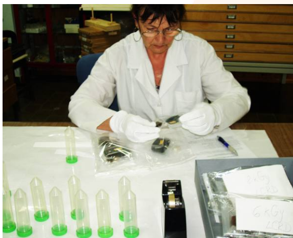
Preparación de muestras de negativos de fotografías para realizar irradiaciones a distintas dosis y evaluar resultados.
