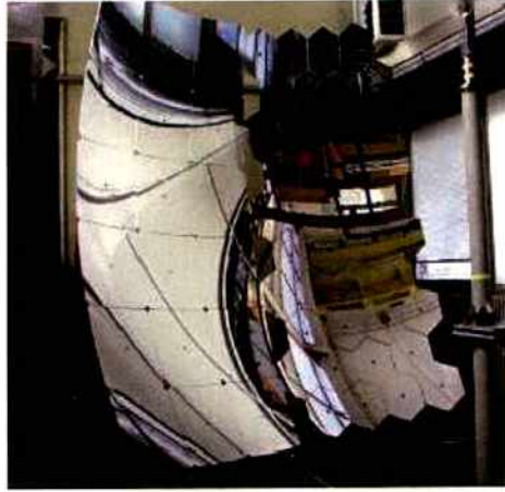
Figura 3.8: Segmentos de aluminio (forma cuadrada) y segmentos de vidrio (forma hexagonal) utilizados en los telescopios del FD. Figura extraída de la referencia [60].
