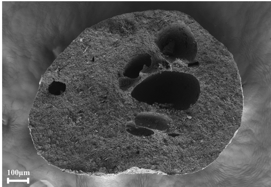
Figura 27. Superficie de fractura pebble sinterizada a 900°C
