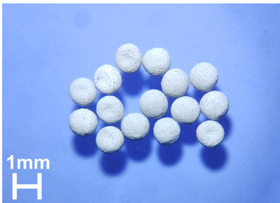
Figura 35. Pebbles sinterizadas a 900°C luego de estar expuestas a una atmósfera reductora (5% H 2 /He) y rampa de temperatura hasta 800°C
