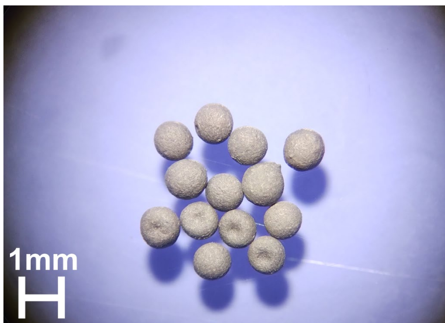
Figura 36. Pebbles sinterizadas a 1100°C luego de estar expuestas a una atmósfera reductora (5% H 2 /He) y rampa de temperatura hasta 800°C
