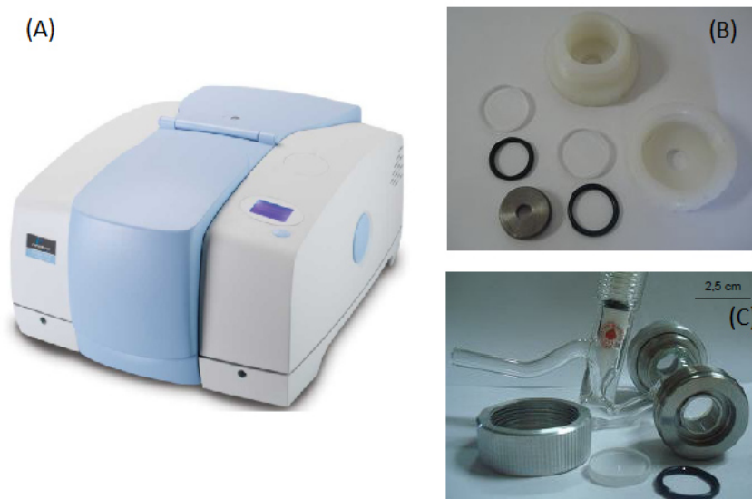
Figura 2.6: Equipo Perkin Elmer Spectrum 400 (A), celda de pastilla para medición de FTIR (B), celda de gases para medición de FTIR (C).
