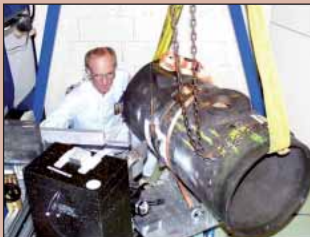
Figura 2. (a) Modelo de recipiente de presión conteniendo un parche en una soldadura, de dimensiones similares al componente de una central nuclear tipo AGR.
