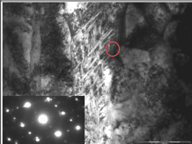
Grano hidrurado a 27500X. El DP fue tomado de la zona indicada y corresponde a \alpha Zr.
