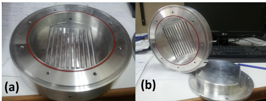
Figura 5.5: Blanco maquinado para la irradiación de materiales, en el acelerador de 200 kV, para estudiar el daño por radiación. (a) base, (b) tapa y base.
