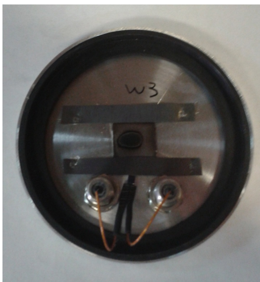
Figura 6.1: Imagen de la copa de Faraday empleada para montar el depósito de Be. La impronta del haz puede verse sobre la superficie del depósito.
