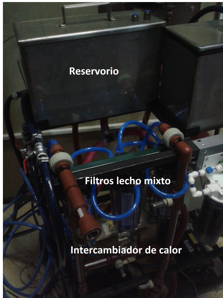
Figura 5.10: Imagen del sistema de desionización de agua implementado.
