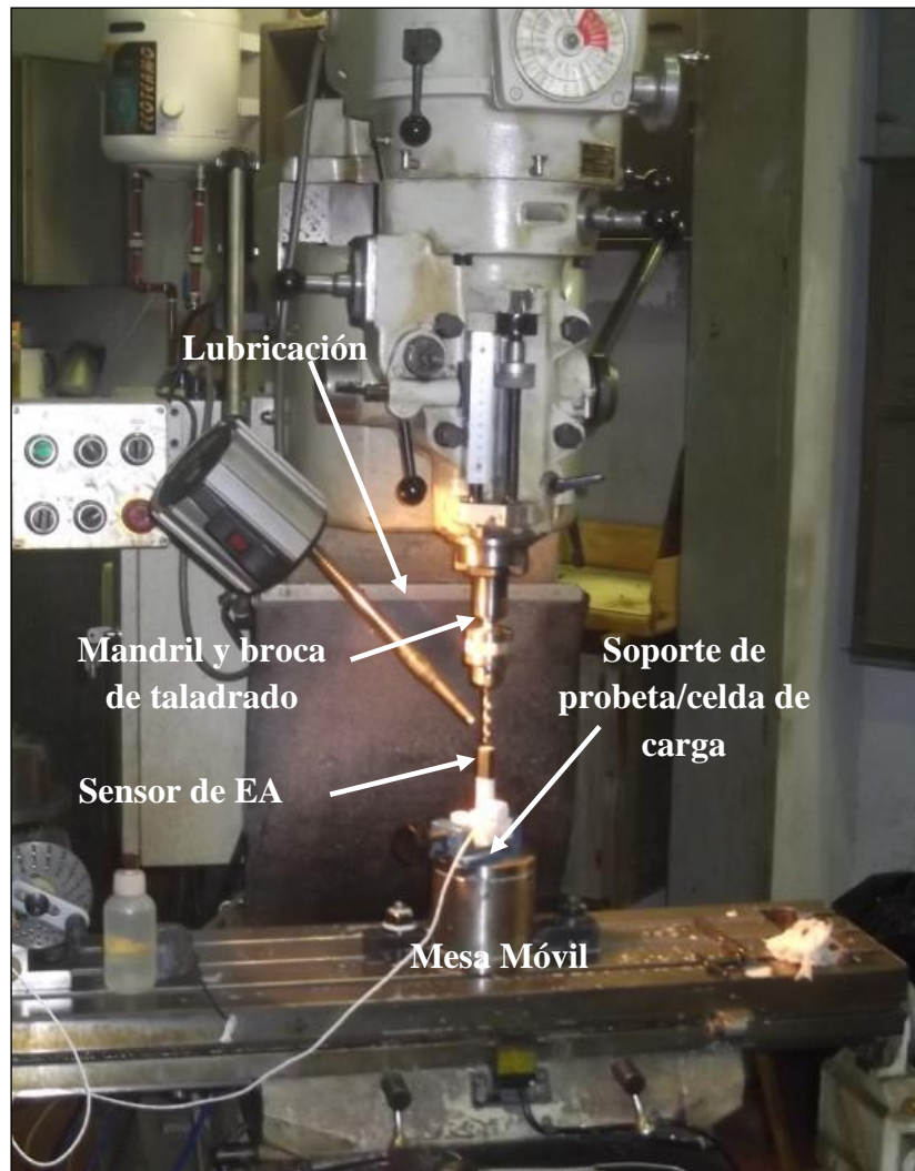
Fig. 4.13 Detalle de las partes del montaje experimental sobre maquina taladradora.
