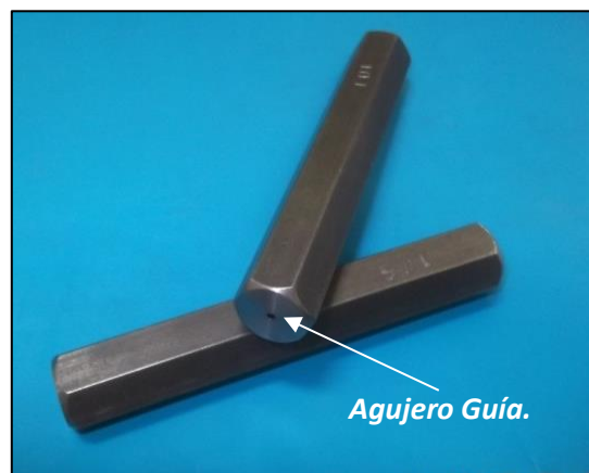
Fig. 4.8 Fotografía de probeta exponiendo el Agujero Guía.
