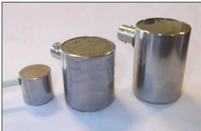
Fig. 2.7 De izquierda a derecha: Sensor miniatura banda ancha, sensor con preamplificador sintonizado, sensor con preamplificador banda ancha.
