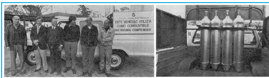
Figura 20: Primer vehículo adaptado para funcionar a GNC del país.
