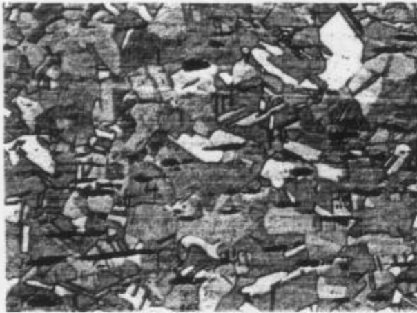
(a) Tamaño de grano: 100% de 40 a 50 \mu\text{m} (200X).
