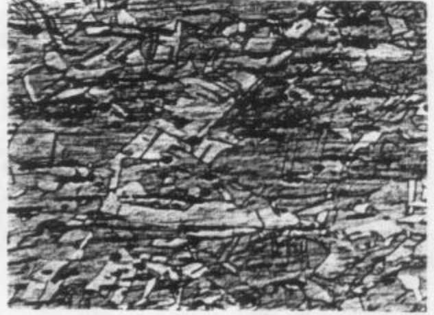
(b) deformado a 30% de reduccion (200X).
