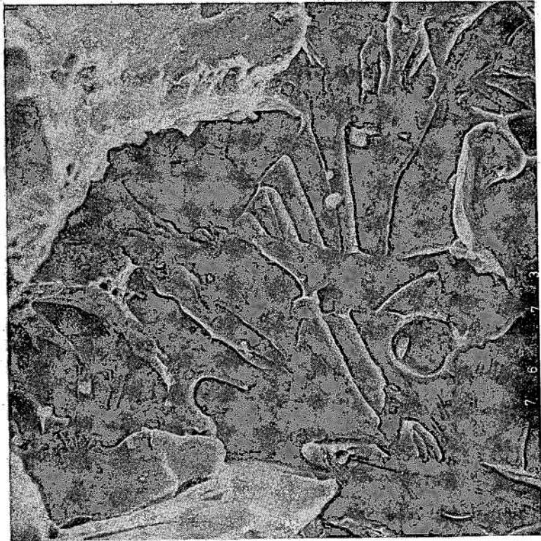
Fig.4 Micrografía de una superficie de fractura frágil en acero obtenida con el microscopio electrónico de barrido. Nótese las superficies de clivaje y ríos característicos de este tipo de fractura. M = 1500 x
