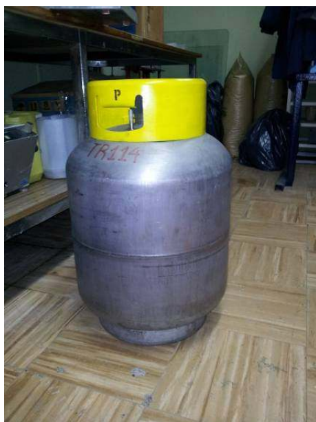
Figura 2.c Garrafa de 50 litros (garrafa) Diámetro: 42 cm Altura: 64 cm Peso: 22 Kg (con tapa)
