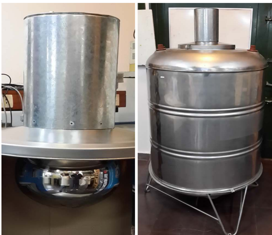
Figura 1: Vista del detector Cherenkov (derecha) con su tubo fotomultiplicador de 8" (izquierda)
