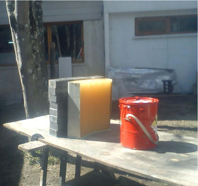
Figura 2: a) Esquema del detector con el blindaje de plomo y de parafina+cadmio utilizado junto a la fuente de neutrones. b) Foto de la configuración de fuente y blindaje utilizada
