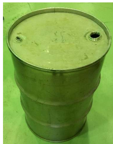
Figura 2.b Tambor de 200 litros Diámetro: 60 cm Altura: 87cm Peso: 25 Kg (con tapa)
