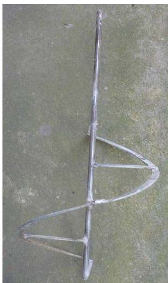
Paletas y agujereadora de banco utilizadas en la realización de lotes (batch) de cementado a escala 20 litros.
