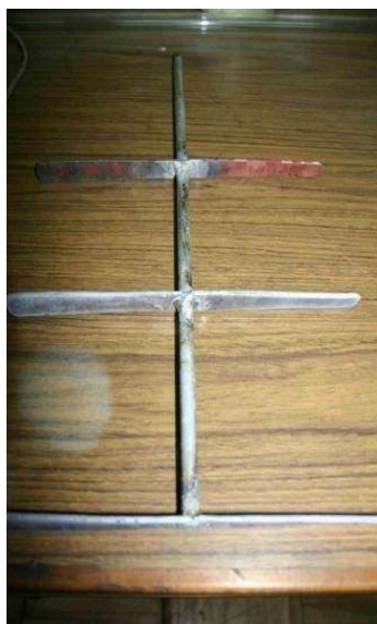
Paletas y agujereadora de banco utilizadas en la realización de lotes (batch) de cementado a escala 20 litros.
