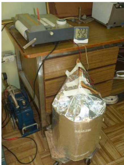
Figura 4. Registro de temperaturas durante el fraguado - escala 20 litros. Ensayo correspondiente a la formulación con vermiculita, bentonita, cemento CPF y residuo con 0,3 % de aluminio
