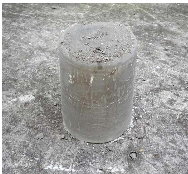
Figura 5. Izquierda: Ensayo de caída desde 5 metros para espécimen con residuos líquidos simulados no activos cementados, escala 20 litros – Derecha: Especimen conservando excelente integridad después de la caída
