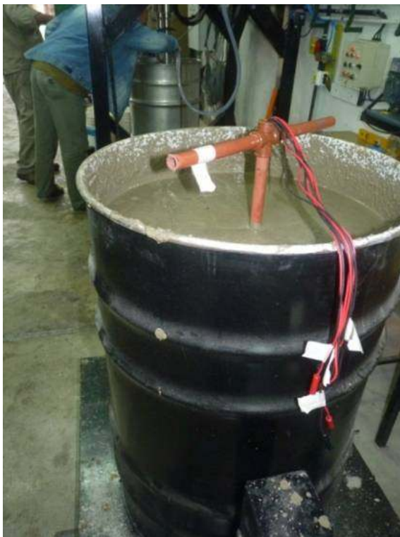
Figura 6. Armado del dispositivo para registro de temperatura durante el fragüe—escala 200 litros. Registro de temperaturas durante el fragüe, correspondiente a la formulación con vermiculita, bentonita, cemento CPC y residuo con 0,3 % de aluminio. T max en ensayo a escala 20 litros: 60°C en el punto central a las 20 horas – en ensayo a escala 200 litros T max = 34 °C, a las 12 horas
