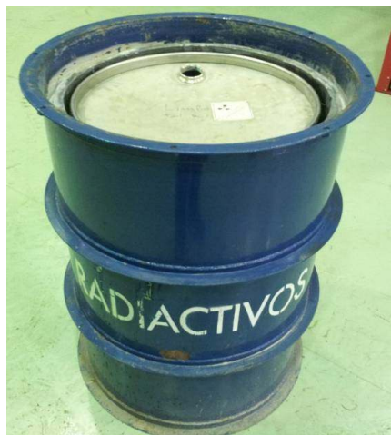
Figura 2.a Tambor de 400 litros, con blindaje interno de cemento y 1,5 cm de plomo y tambor de 200 litros Diámetro: 88 cm Altura: 100 cm Peso: 450 Kg (con tapa)
