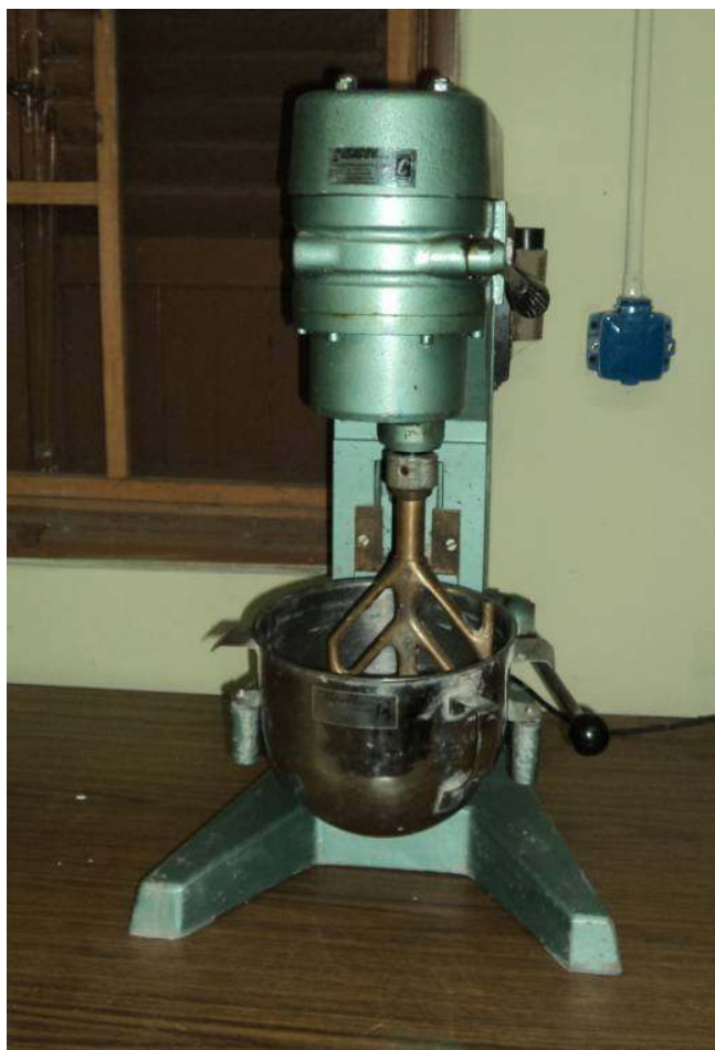
Mezcladora normalizada de cemento de laboratorio capacidad 2 litros
