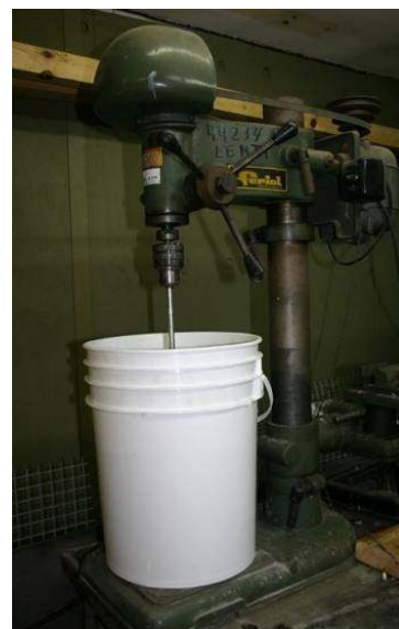
Paletas y agujereadora de banco utilizadas en la realización de lotes (batch) de cementado a escala 20 litros.
