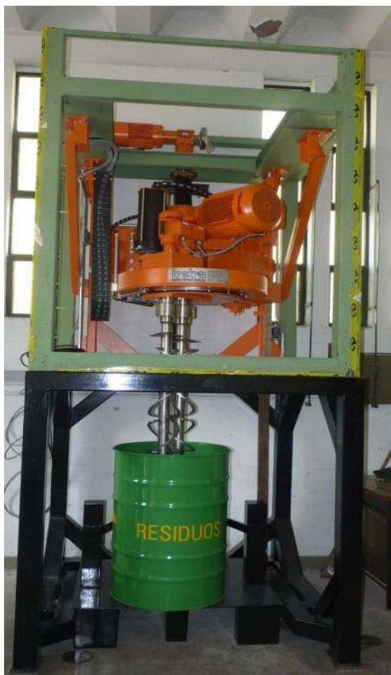
Mezcladora "in drum" de cemento BEBA para tambores de 200 litros
