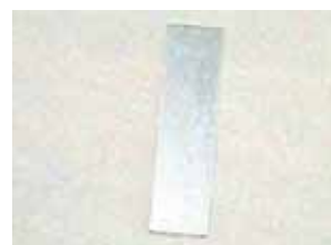
Figura 2. Placas de Al 6061 que contienen entre sí el combustible ( U_3Si_2 ) + 20% de aluminio en polvo
