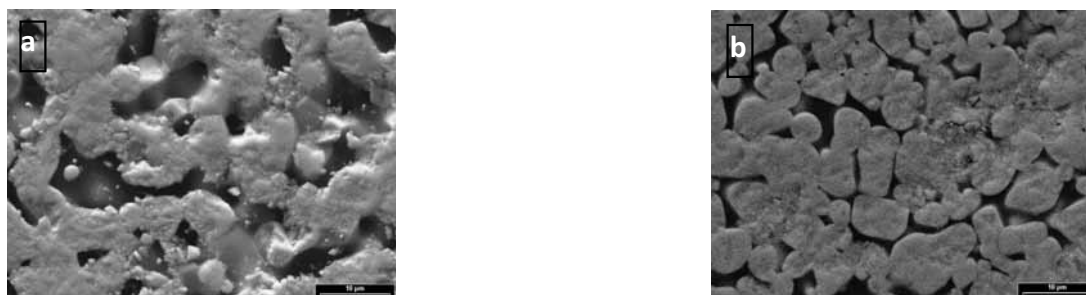
Figura 5. Micrografías para: a) muestra sin adición de vidrio y b) muestra con 10% de VG98
