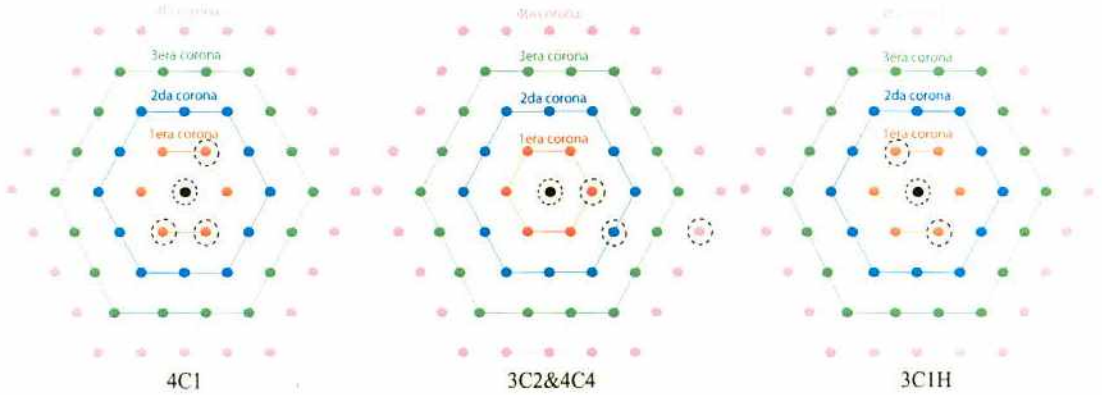
Figura 3.20: Distintas configuraciones de disparo de los detectores de superficie según la clasificación del Central Trigger. Los eventos se clasifican según estas configuraciones teniendo en cuenta además que el patrón temporal corresponda a la propagación de la cascada a la velocidad de la luz.
