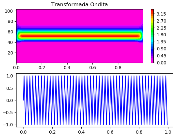
Figura 51. Transformada Ondita para un tono puro (arriba). Tono puro en el dominio temporal (abajo).
