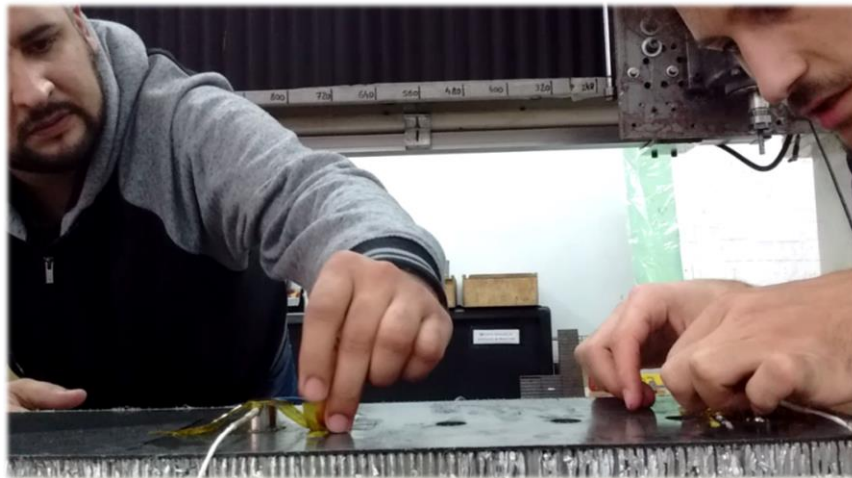
Figura 53. Colocación de los sensores de EA.
