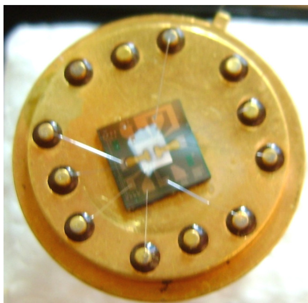
Figura 6.27: Microsensor con película sensora de \text{SnO}_2 (obtenida por PW).
