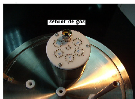
Detalle de soporte de sensores
