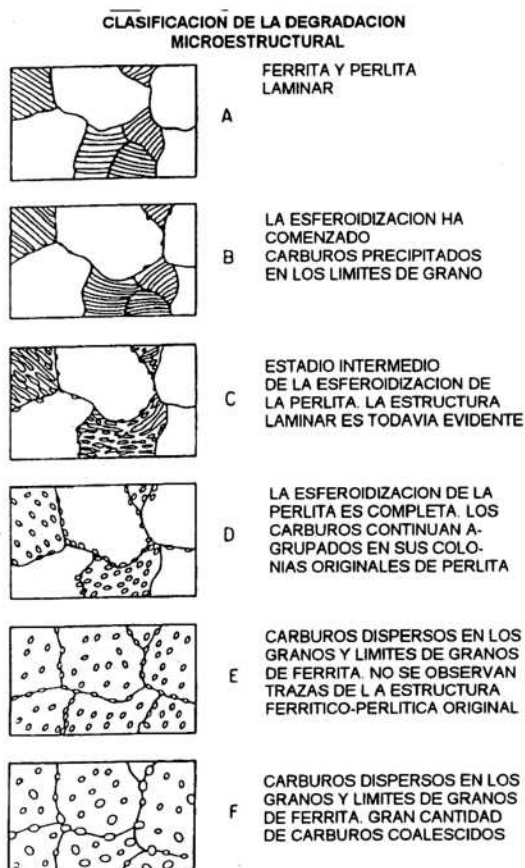
Fig.III.7 - Clasificación del daño por creep a partir de la evolución de la microestructura
