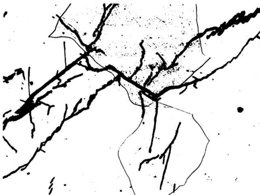
Figs.III.13 -Fotomicrografía mostrando el fenómeno de corrosión bajo tensión en un acero inoxidable austenítico.
