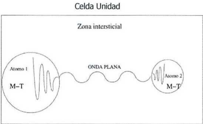
Figura 2.1: Esquema de una onda plana aumentada y de la celda unidad de un cristal dividida en la región intersticial y las esferas de muffin-tin (M-T) de cada átomo en la celda.
