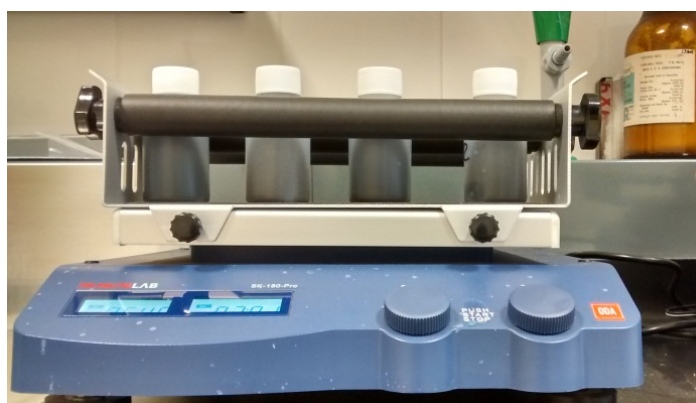
Figura 12: Adsorción de Zn^{2+} sobre magnetita a temperatura ambiente, para I = 0,1M KNO_3 y (m/V) = 4 g L^{-1} . El tiempo de equilibrio fue de 3 horas con agitación mecánica en agitador orbital a 530 rpm. El pH se ajustó mediante la adición de NaOH 0,1 o 0,01M.
