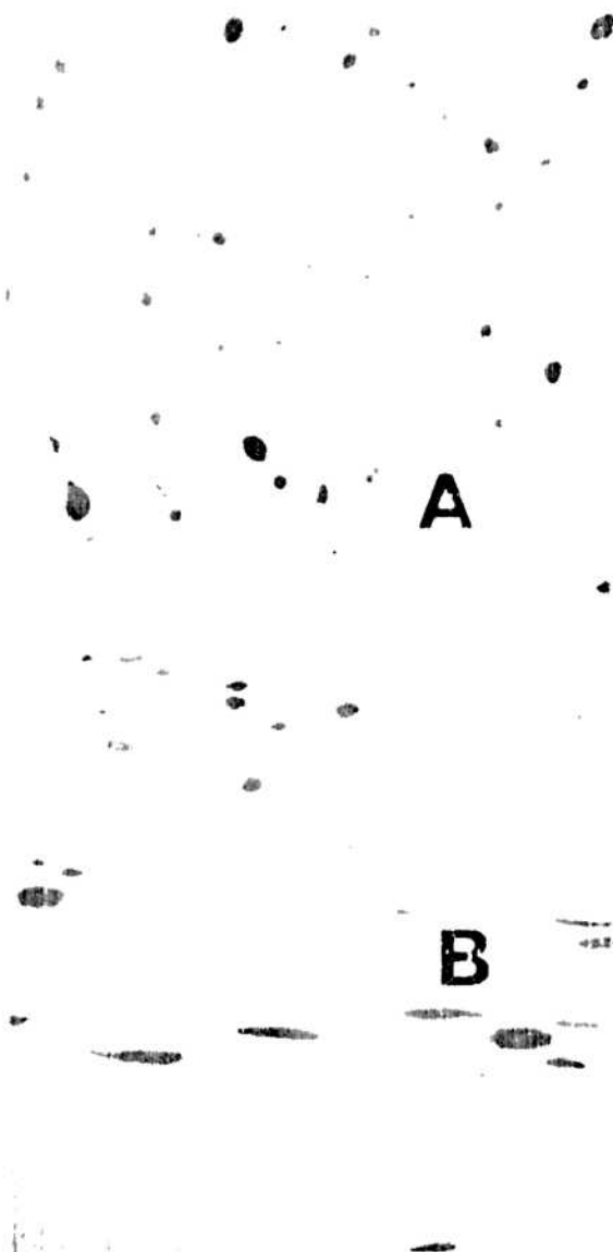
Figura 1- Observación de inclusiones por microscopía óptica. x 500 aumentos. Zona - A, corte de la probeta trans versal a la dirección de laminación. Zona B, corte longitudinal a la dirección de laminación.
