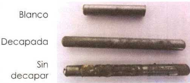
Figura5.83. Imagen del blanco y de dos de las cuatro barras de acero SAE 1040 de la Serie 2, a los 1160 días de exposición.
