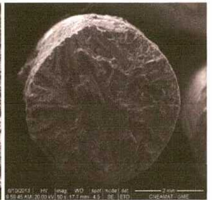
(c) Superficie de fractura de una de las barras sin decapar después de 1160 días, Serie 2.
