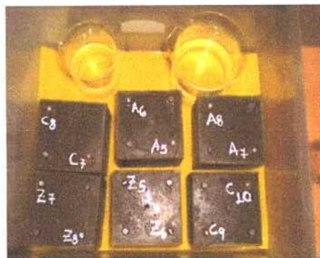
Probetas desmoldadas a las 24 hs de la Probetas desmoldadas en cámara colada y con las identificaciones de curado (98% HR) durante 28 correspondientes de las barras. días.
