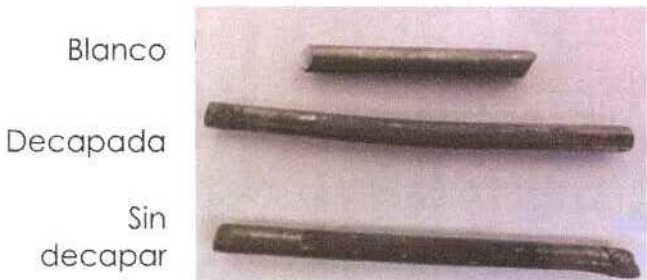
Figura 5.108. Imagen del blanco y de dos de las cuatro barras de plomo de la Serie 1, a los 1200 días de exposición.
