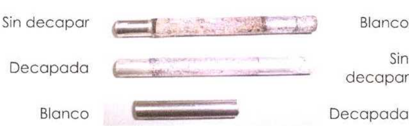
Figura 5.23. Imagen del blanco y de dos de las cuatro barras de aluminio de la Serie 5, a los 560 días de exposición.
