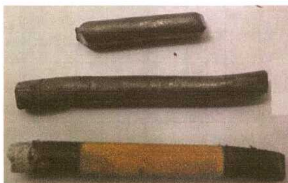
Figura 6.36. Imagen del blanco, de las barras de plomo decapada y sin decapar (de arriba hacia abajo) de la Serie 5, a los 792 días de exposición.
