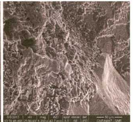
(f) Barra decapada después de estar 1160 días, Serie 2.
