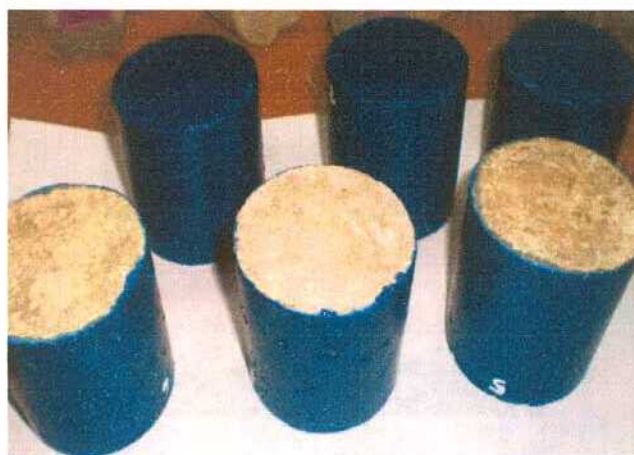
Figura 4.24. Probetas de mortero, empleadas en los ensayos de difusión de cloruro, según norma Nordtest Method Build 443.
