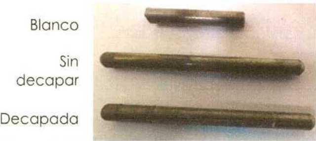
Figura 5.84. Imagen del blanco y de dos de las cuatro barras de acero SAE 1040 de la Serie 3, a los 1110 días de exposición.
