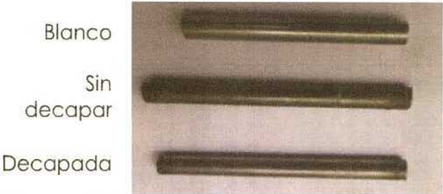
Figura 5.167. Imagen del blanco y de dos de las cuatro barras de acero inoxidable AISI 304 de la Serie 4, a los 1110 días de exposición.
