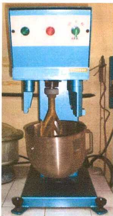
Figura 4.2. Imágenes de la mezcladora de mortero COSACOV, empleada en la fabricación de las probetas.
