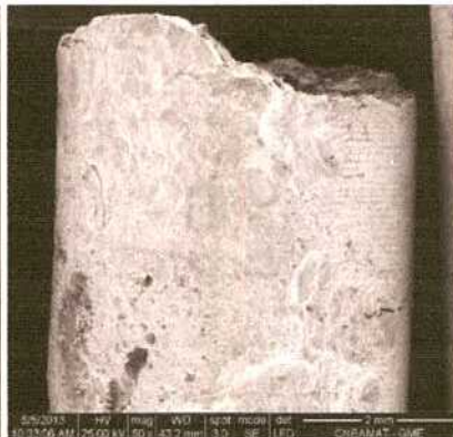
(e) Barra decapada después de estar 1160 días, Serie 2.
