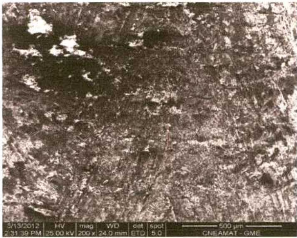
Figura 5.61. Micrografía de la superficie de la barra de cinc decapada, después de estar embebida en mortero durante 766 días, Serie 1.
