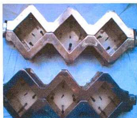
Moldes de fundición con las bases plásticas y las barras
