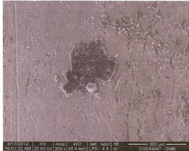
Figura 5.95. Micrografía de la barra de acero SAE 1040 después de estar embebida en mortero sumergido en agua de mar durante 771 días, Serie 4. En la imagen se observan los productos de corrosión formados sobre la superficie metálica de la barra, sin decapar.
