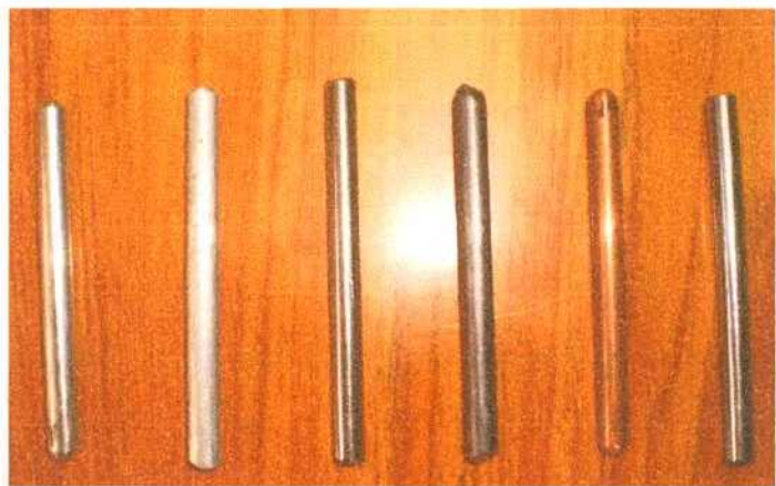
Figura 4.1. Barras de los metales y aleaciones ensayadas. De izquierda a derecha: aluminio, cinc, acero SAE 1040, plomo, cobre y acero inoxidable AISI 304.
