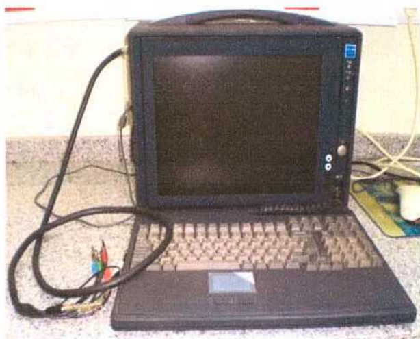
Figura 4.13. Potenciostato-galvanostato Gamry (ACMEII 843), utilizado en las mediciones de los parámetros electroquímicos.
