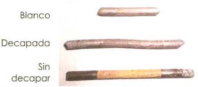
Figura 5.113. Imagen del blanco y de dos de las cuatro barras de plomo de la Serie 6, a los 788 días de exposición.
