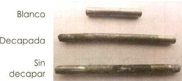
Figura 5.56. Imagen del blanco y de dos de las cuatro barras de cinc de la Serie 3, a los 1110 días de exposición.
