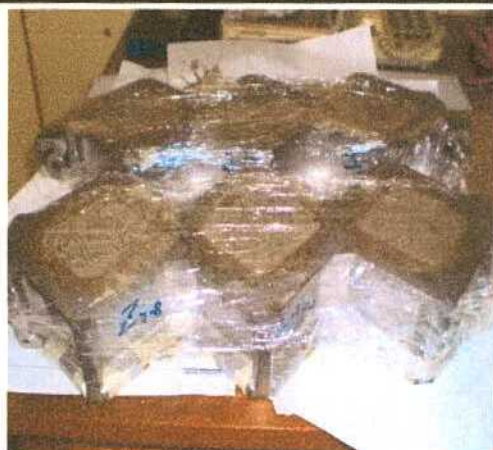
Moldes con la mezcla y cubiertos con film durante 24 hs.
