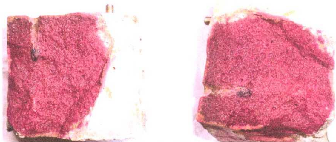
Figura 5.191. Probeta de la Serie 3 a los 773 días de estar en un medio de 98% HR, donde se observa que el frente de carbonatación no ha penetrado en el mortero.
