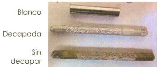
Figura 5.21. Imagen del blanco y de dos de las cuatro barras de aluminio de la Serie 3, a los 1110 días de exposición.
