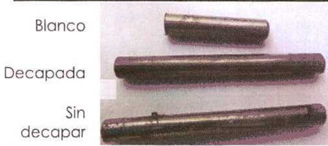
Figura 5.86. Imagen del blanco y de dos de las cuatro barras de acero SAE 1040 de la Serie 5, a los 792 días de exposición.
