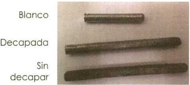
Figura 5.59. Imagen del blanco y de dos de las cuatro barras de cinc de la Serie 6, a los 788 días de exposición.
