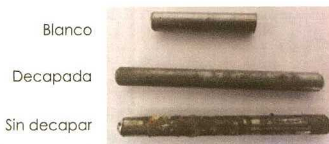
Figura 6.30. Imagen del blanco y de dos de las cuatro barras de acero SAE 1040 de la Serie 2, a los 1160 días de exposición.
