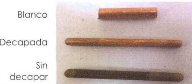
Figura 5.138. Imagen del blanco y de dos de las cuatro barras de cobre de la Serie 1, a los 1200 días de exposición.
