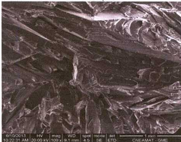
(e) Superficie de fractura de una de las barras de cinc sin decapar.
