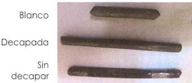
Figura 5.109. Imagen del blanco y de dos de las cuatro barras de plomo de la Serie 2, a los 1160 días de exposición.
