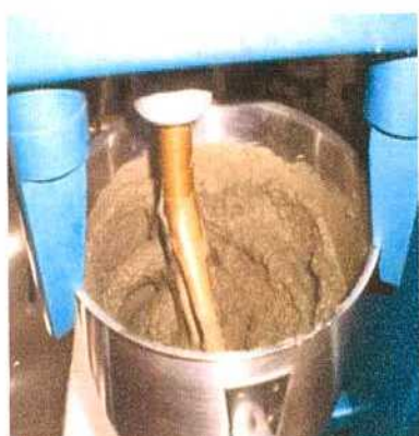
Mezcla de agua, arena y cemento (mortero)
