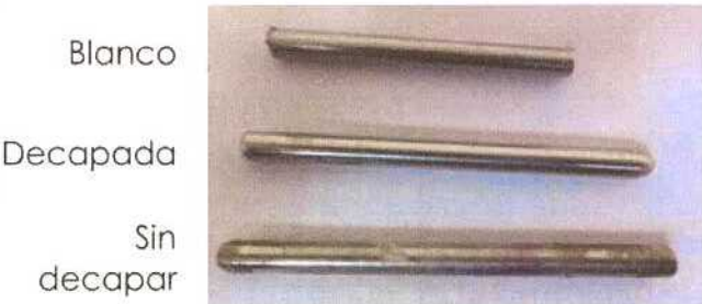
Figura 5.165. Imagen del blanco y de dos de las cuatro barras de acero inoxidable AISI 304 de la Serie 2, a los 1160 días de exposición.
