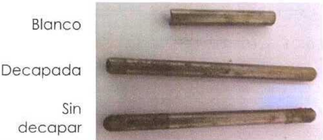
Figura 5.82. Imagen del blanco y de dos de las cuatro barras de acero SAE 1040 de la Serie 1, a los 1200 días de exposición.
