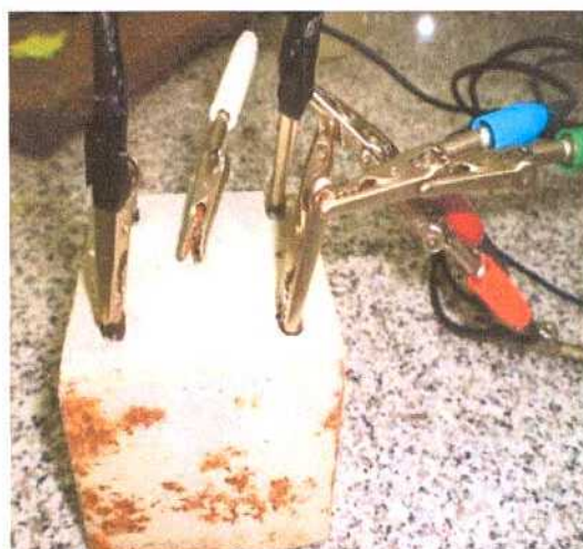
Figura 4.14. Conexiones entre los contactos eléctricos del equipo y los electrodos de las probetas para las mediciones de R_p y potencial de corrosión.
