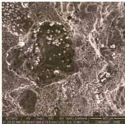
(b) Barra decapada después 772 días, Serie 2.
