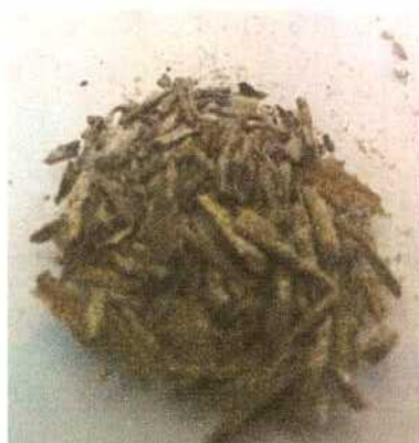
Figura 5.26. Productos de corrosión separados de la barra de aluminio, A24, Serie 6, 788 días.
