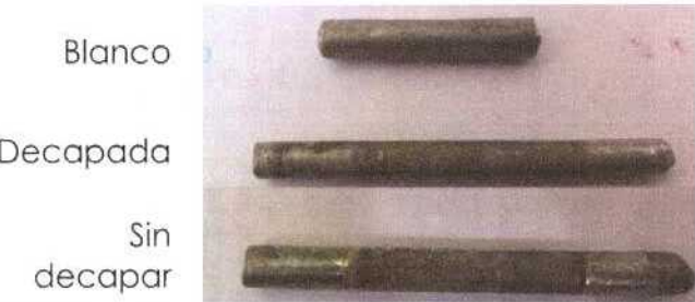
Figura 5.54. Imagen del blanco y de dos de las cuatro barras de cinc de la Serie 1, a los 1200 días de exposición.
