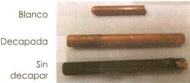
Figura 5.142. Imagen del blanco y de dos de las cuatro barras de cobre de la Serie 5, a los 792 días de exposición.
