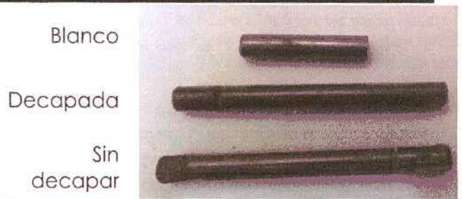
Figura 5.87. Imagen del blanco y de dos de las cuatro barras de acero SAE 1040 de la Serie 6, a los 788 días de exposición.
