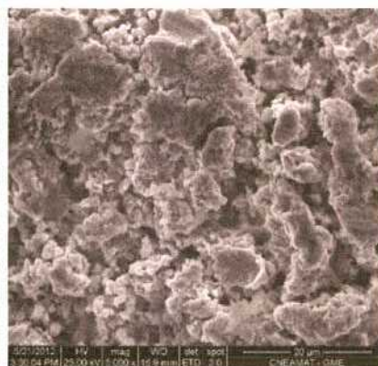
(c) Barra decapada después de 772 días, Serie 2.
