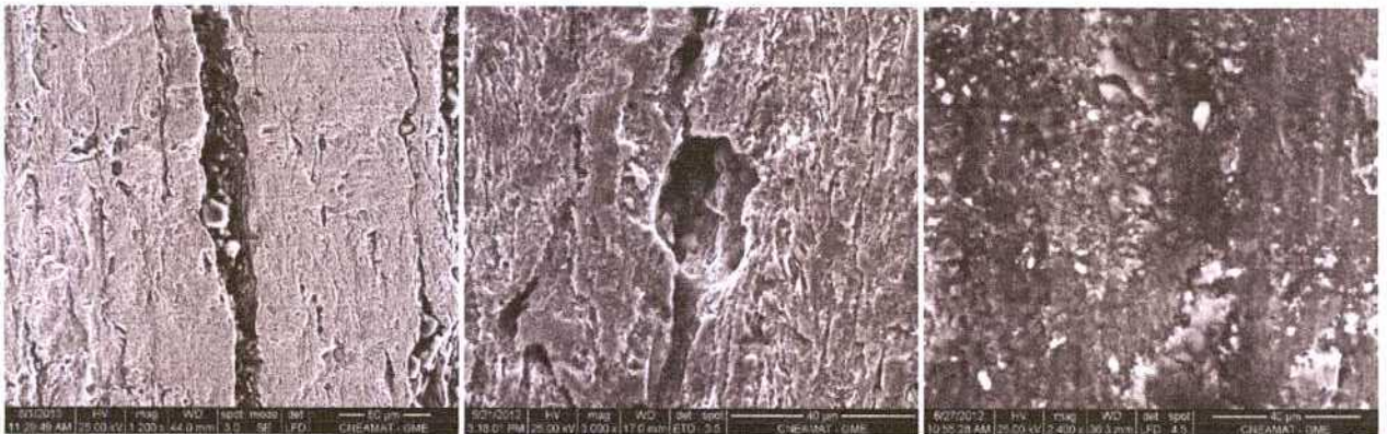
(a) Barra decapada, después de 1200 días, Serie 1. (b) Barra decapada, después de 772 días, Serie 2. (c) Barra sin decapar, después de 773 días, Serie 3.
