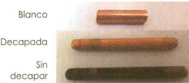
Figura 5.140. Imagen del blanco y de dos de las cuatro barras de cobre de la Serie 3, a los 1110 días de exposición.
