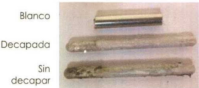
Figura 5.20. Imagen del blanco y de dos de las cuatro barras de aluminio de la Serie 2, a los 1160 días de exposición.
