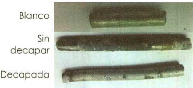
Figura 5.57. Imagen del blanco y de dos de las cuatro barras de cinc de la Serie 4, a los 1110 días de exposición.
