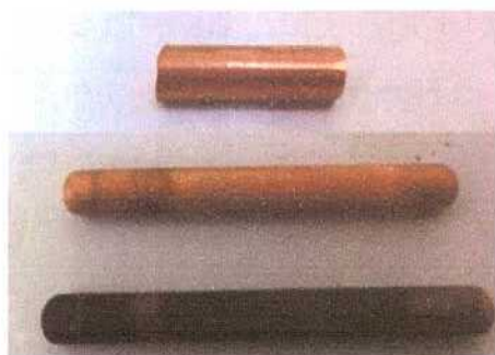
Figura 6.41. Imagen del blanco y de dos de las cuatro barras de cobre de la Serie 3, decapada y sin decapar, a los 1110 días de exposición.
