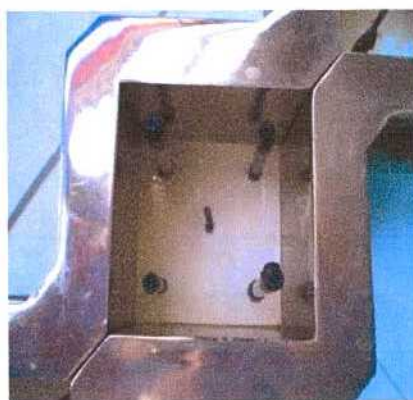
Moldes de fundición con las bases plásticas y las barras
