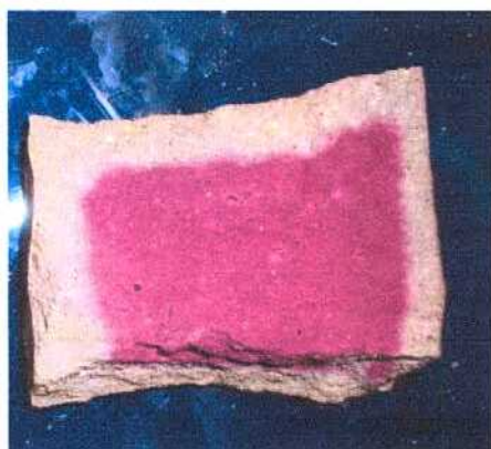
Figura 4.23. Mortero rociado con fenolftaleína, donde pueden apreciarse las dos situaciones de coloración; la zona fucsia que aún es alcalina y la zona no coloreada correspondiente a la parte carbonatada.
