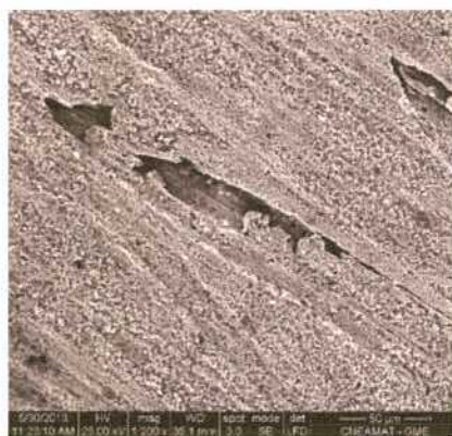
(a) Barra sin decapar después de 1200 días, Serie 1.
