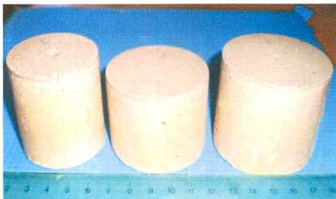
Figura 4.22. Imagen de los cilindros de mortero empleados en los ensayos para determinar coeficientes de carbonatación y difusión de cloruro.
