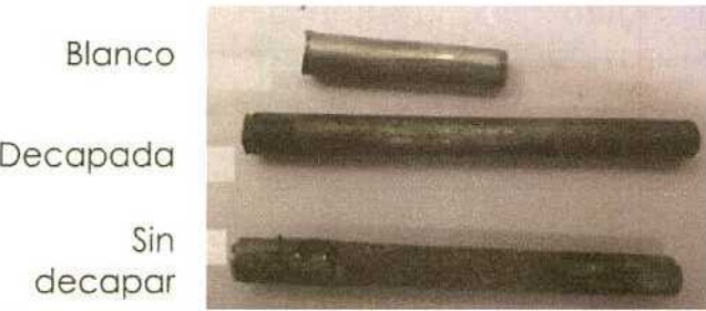
Figura 5.58. Imagen del blanco y de dos de las cuatro barras de cinc de la Serie 5, a los 792 días de exposición.
