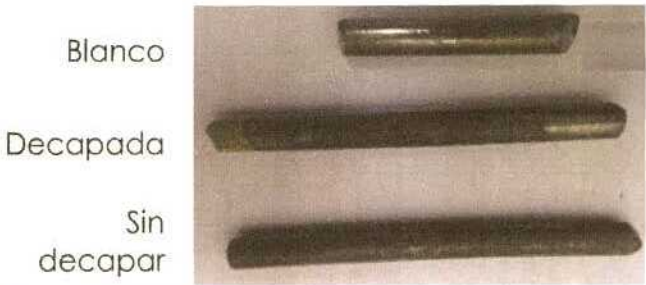
Figura 5.111. Imagen del blanco y de dos de las cuatro barras de plomo de la Serie 4, a los 1110 días de exposición.
