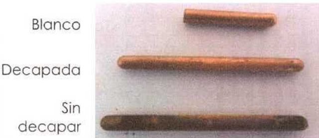
Figura 5.139. Imagen del blanco y de dos de las cuatro barras de cobre de la Serie 2, a los 1160 días de exposición.
