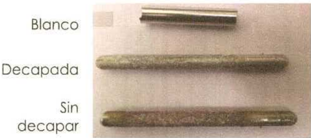
Figura 5.19. Imagen del blanco y de dos de las cuatro barras de aluminio de la Serie 1 a los 1200 días de exposición.
