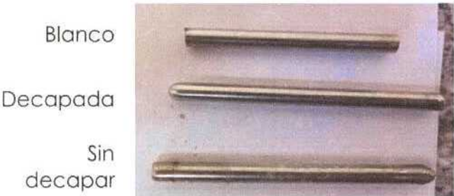
Figura 5.164. Imagen del blanco y de dos de las cuatro barras de acero inoxidable AISI 304 de la Serie 1, a los 1200 días de exposición.
