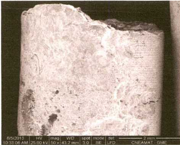
(a) Superficie de la barra de cinc fracturada decapada.
