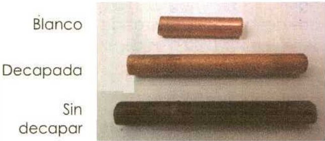
Figura 5.143. Imagen del blanco y de dos de las cuatro barras de cobre de la Serie 6, a los 788 días de exposición.
