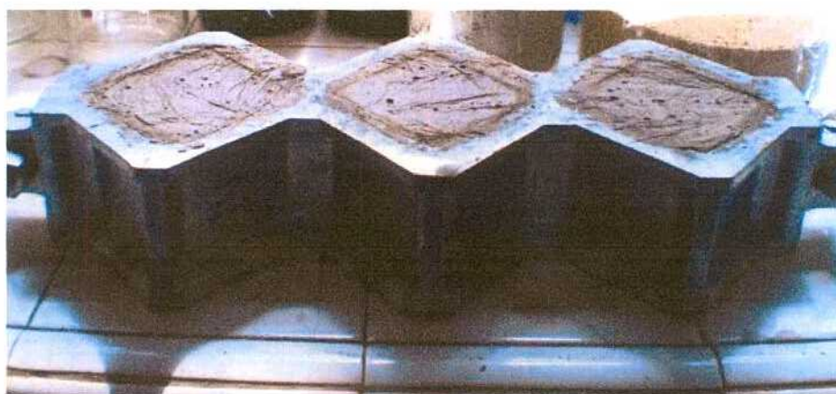
Mezcla endurecida previa al desmolde.
