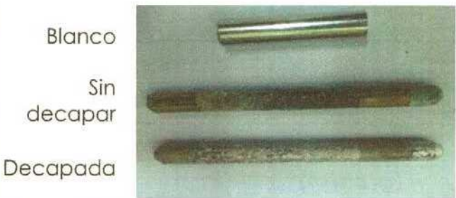
Figura 5.22. Imagen del blanco y de dos de las cuatro barras de aluminio de la Serie 4, a los 1110 días de exposición.
