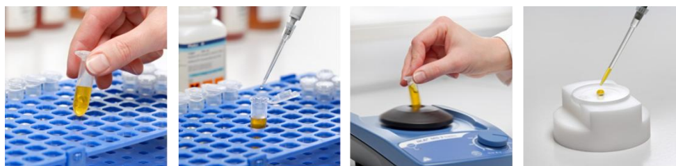
Figura 10. Procedimiento de preparación de muestras para TXRF. Agregado de estándar interno (galio 1 mg/L) sobre 1 mL de muestra, homogeneización y sembrado de 5 \mu\text{L} sobre el reflector.
