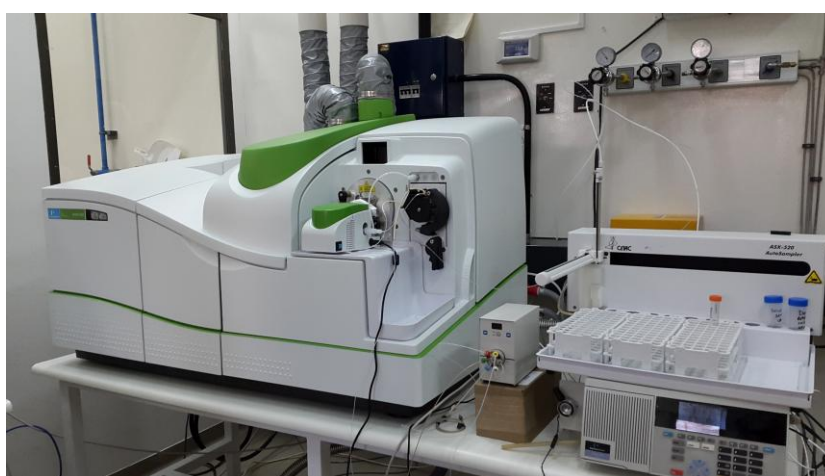
Figura 12. Espectrómetro de masas por plasma inductivamente acoplado NexION 300X Perkin Elmer.
