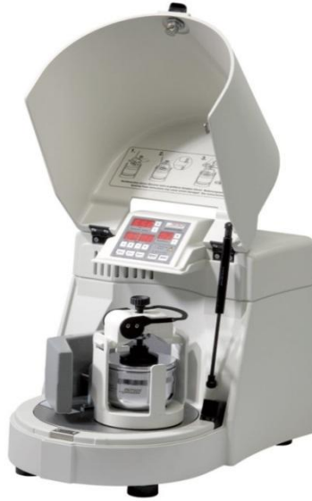
Figura 18. Molino mono planetario Pulverisette6 de Fritsch utilizado para la molienda y homogeneización de las muestras de mineral.
