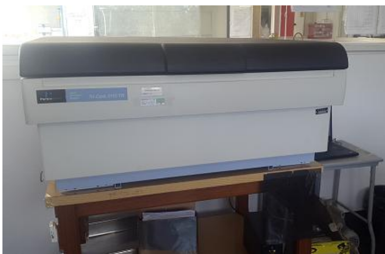
Figura 16. Contador de centelleo líquido TriCarb 3110TR. Perkin Elmer \alpha/\beta .
