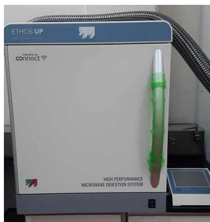
Figura 19. Digestor por microondas Mileston Ethos UP utilizado para la digestión de las muestras sólidas.
