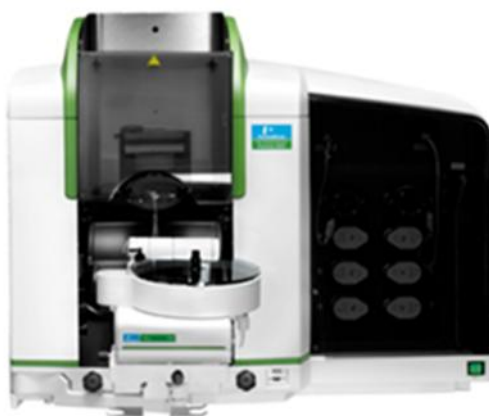
Figura 15. Espectrómetro de absorción atómica PinAAcle 900T Perkin Elmer.
