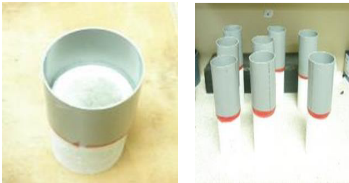
Figura 2.17. Esquema del Sistema para difusión de cloruros.
