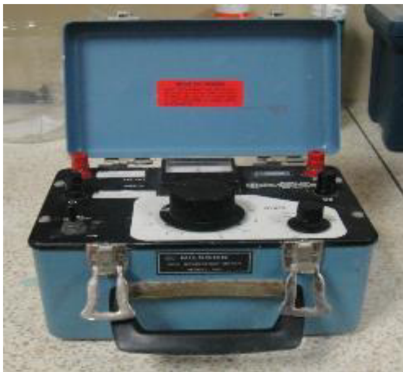
Figura 2.5. Equipo para medir la resistividad del hormigón, Nilsson 400
