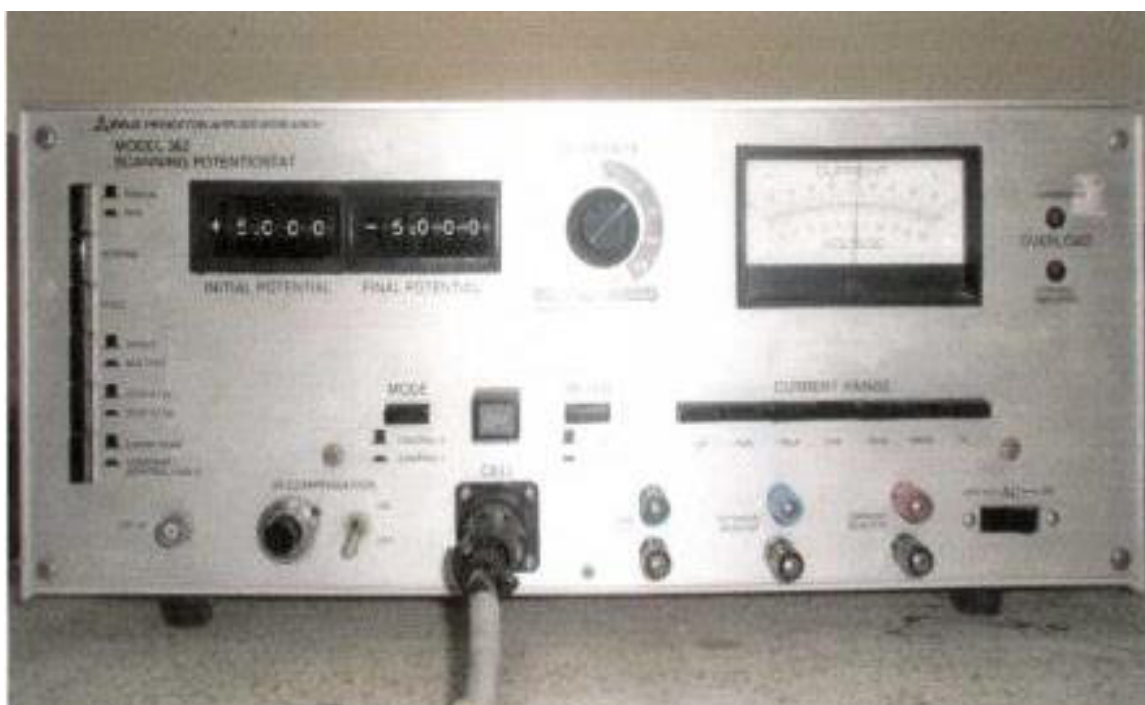
Figura 2.12.- Potenciostato EG&G Princeton Applied Research, modelo 362, que se empleó para los ensayos de resistencia a la polarización lineal R_p . Fuente: Autor.
