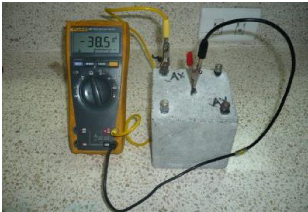
Figura 2.9. Medición del potencial E_{\text{corr}} de las armaduras respecto al electrodo de referencia interno. Fuente: Autor.
