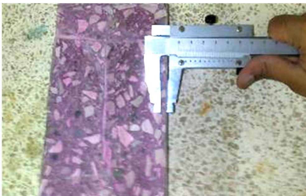
Figura 2.16. Medición del frente carbonatado. Fuente: Autor.
