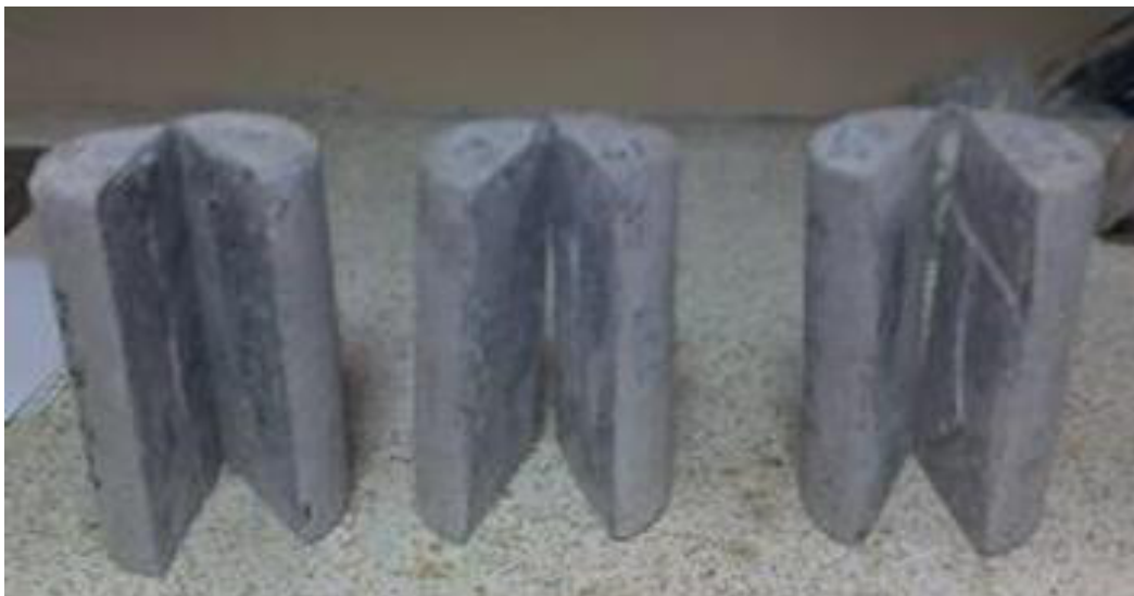
Figura 2.15. Probetas cortadas longitudinalmente para medir el perfil de carbonatación. Fuente: Autor.
