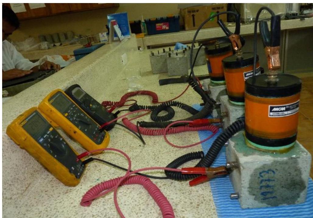
Figura 2.10. Medición de potenciales E_{\text{CSC}} vs electrodo de referencia \text{Cu}/\text{CuSO}_4 (CSC). Fuente: Autor.
