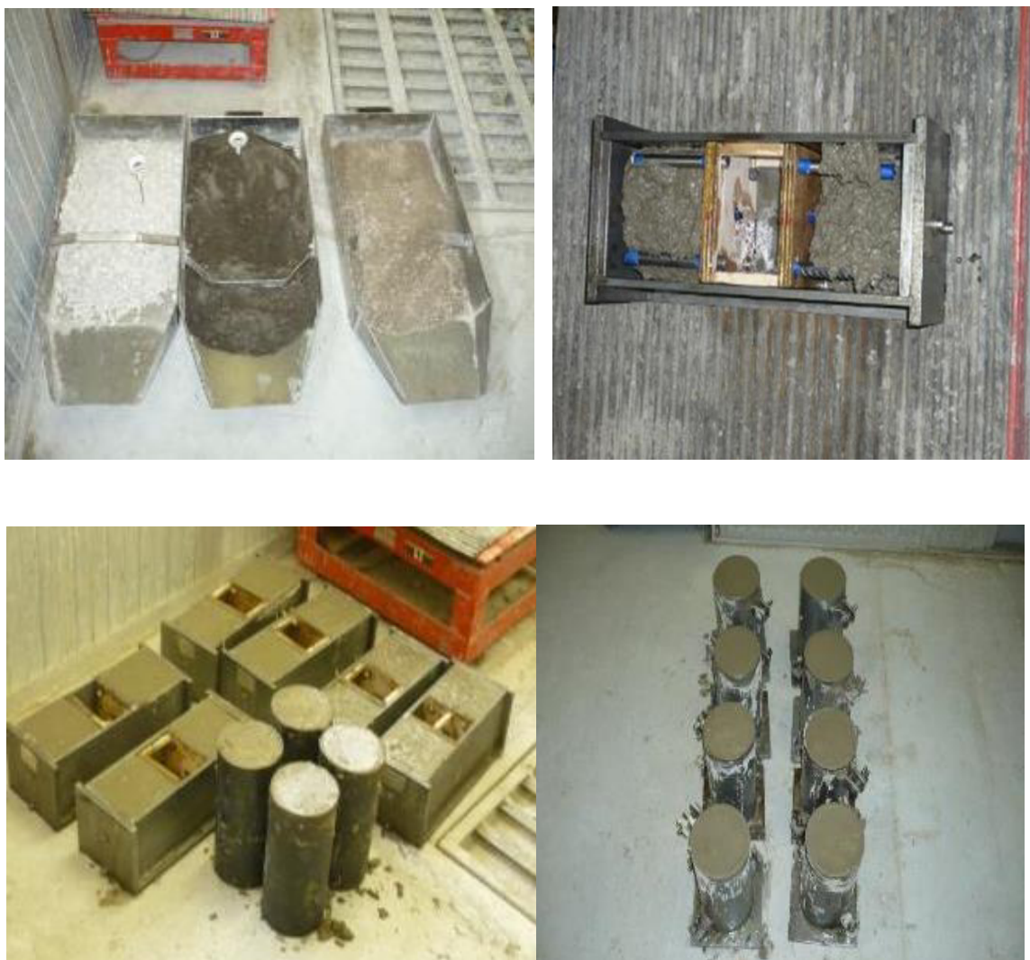
Figura 2.2. Fabricación de probetas en laboratorios del Centro Técnico Hormigón - HOLCIM.
