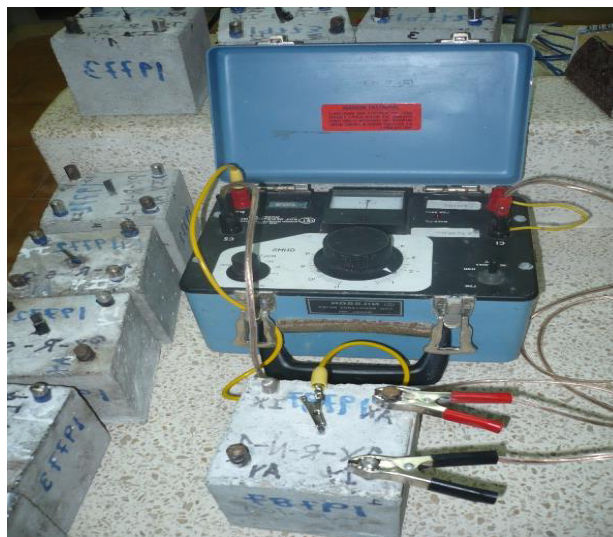
Figura 2.6. Esquema empleado para medición de la resistencia en hormigón. Fuente: Autor.
