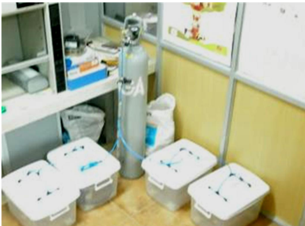
Figura 2.13. Cámaras para ensayos de carbonatación. Fuente: Autor.
