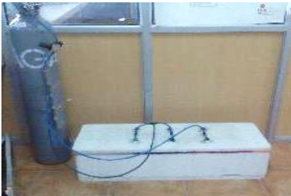
Figura 2.14. Cámara de carbonatación modificada.
