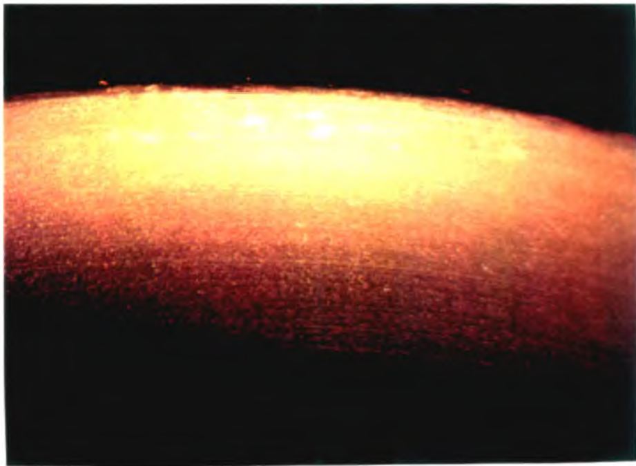
Foto B. Material pegado (Zry) sobre la garganta de un rodillo. El material pegado se reconoce tanto sobre el rodillo como sobre el mandril por su aspecto brillante. 6,6X.
