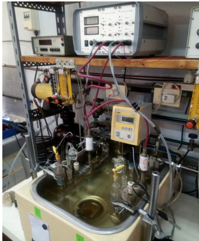
Figura 2.9. Celdas de permeación montadas dentro del baño termostatzado.
