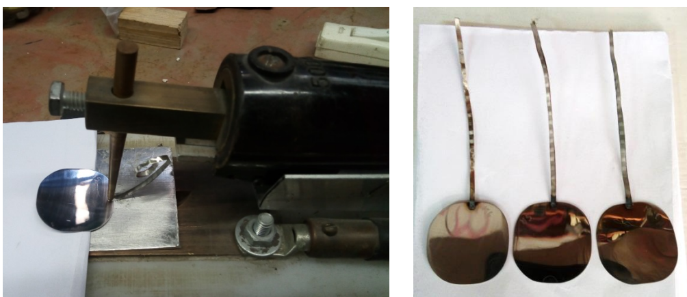
Figura 2.12. Operación de soldadura y probetas de permeación con los terminales ya soldados.
