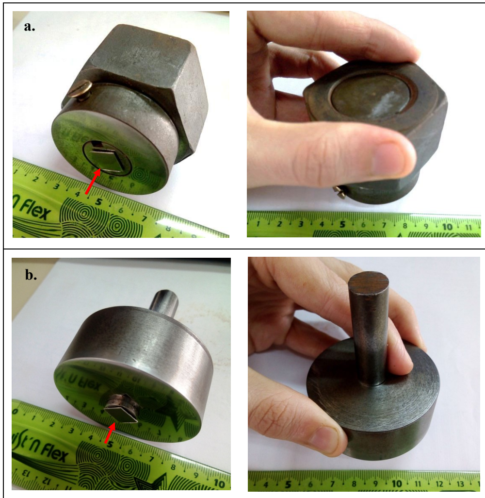
Figura 2.16. Dispositivos utilizados para el adelgazamiento de las muestras (tornillones). Se detallan la colocación de la muestra a adelgazar sobre el dispositivo (izquierda) y la posición de trabajo (derecha) para ambos modelos de tornillón utilizados.
