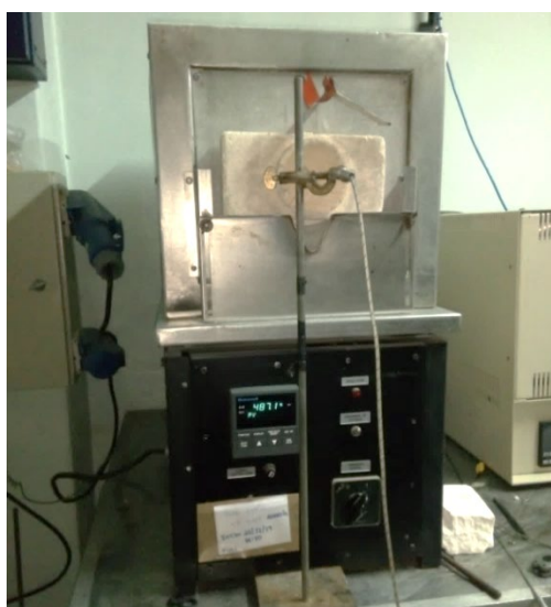
Figura 2.5. Horno utilizado para el tratamiento térmico de 2000 horas.
