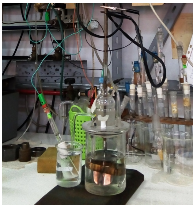
Figura 2.14. Operación de paladiado.
