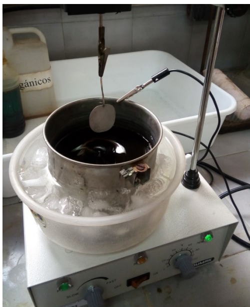
Figura 2.13. Operación de pulido electrolítico.
