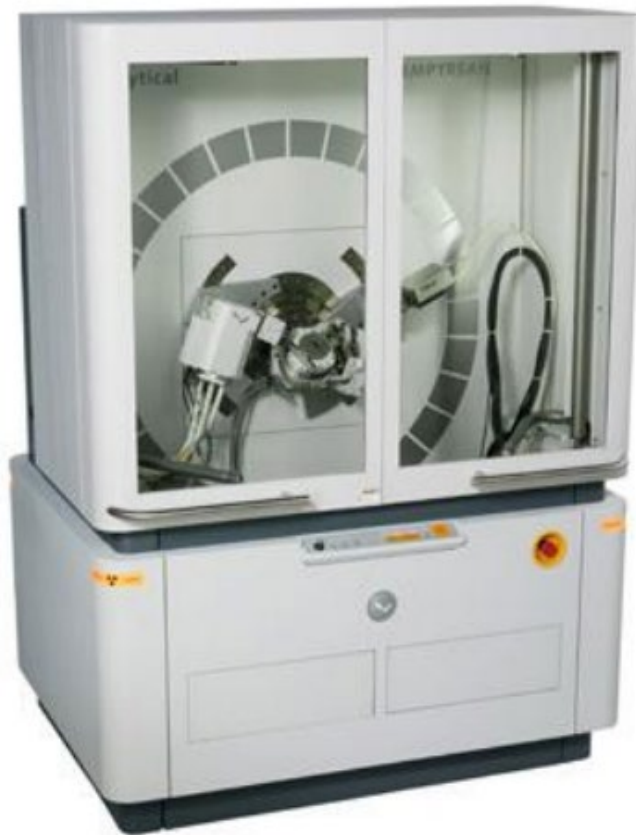
Figura 3.4: Difractómetro de polvos de marca Malvern Panalytical, modelo Empyrean 2.
