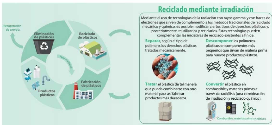
Figura 7. Reciclado mediante radiación (1).
